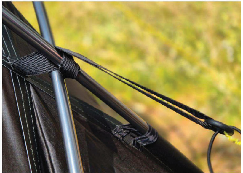
STABILT: På Vern 1 kan bardunfestet legges i en løkke rundt krysningspunktet på teltstengene. Dette stabiliserer krysningspunktet og bidrar også til at vindbelastningen fordeles på alle opphengspunktene på ytterteltet, ikke bare bardunfestet
