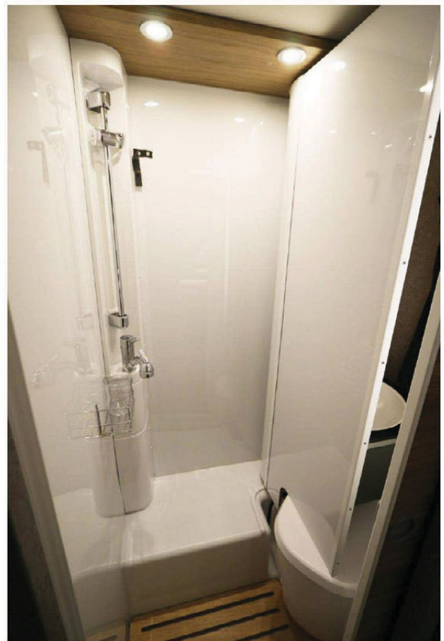
FREM MED DUSJEN: Vegg med vasken kan svinges, noe som åpenbarer et dusjkabinett.
