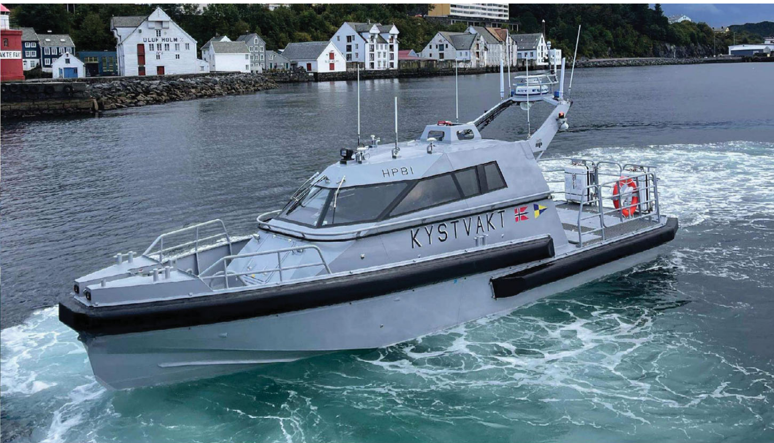
ALUMINIUM: Sjøbjørn 38 er bygget i aluminium, ikke glassfiber som forgjengeren.
