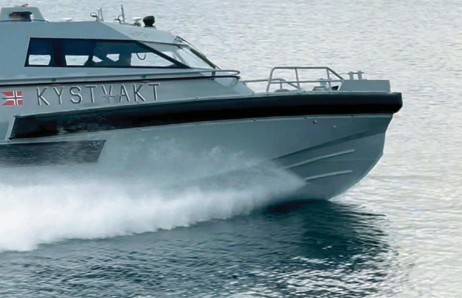
ALUMINIUM: Sjøbjørn 38 er bygget i aluminium, ikke glassfiber som forgjengeren.
