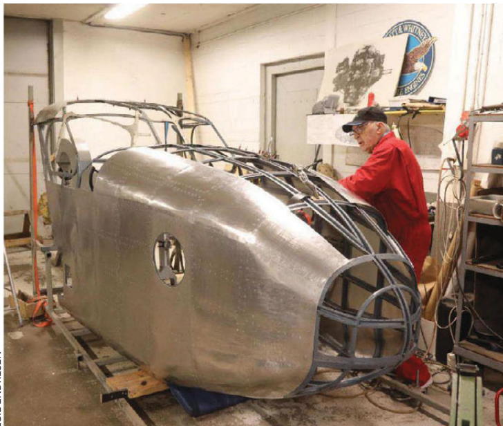
MYE FINARBEID: Neseseksjonen var en av de mest utfordrende oppgavene for restaureringsgjengen, her representert ved Harald Egge.
