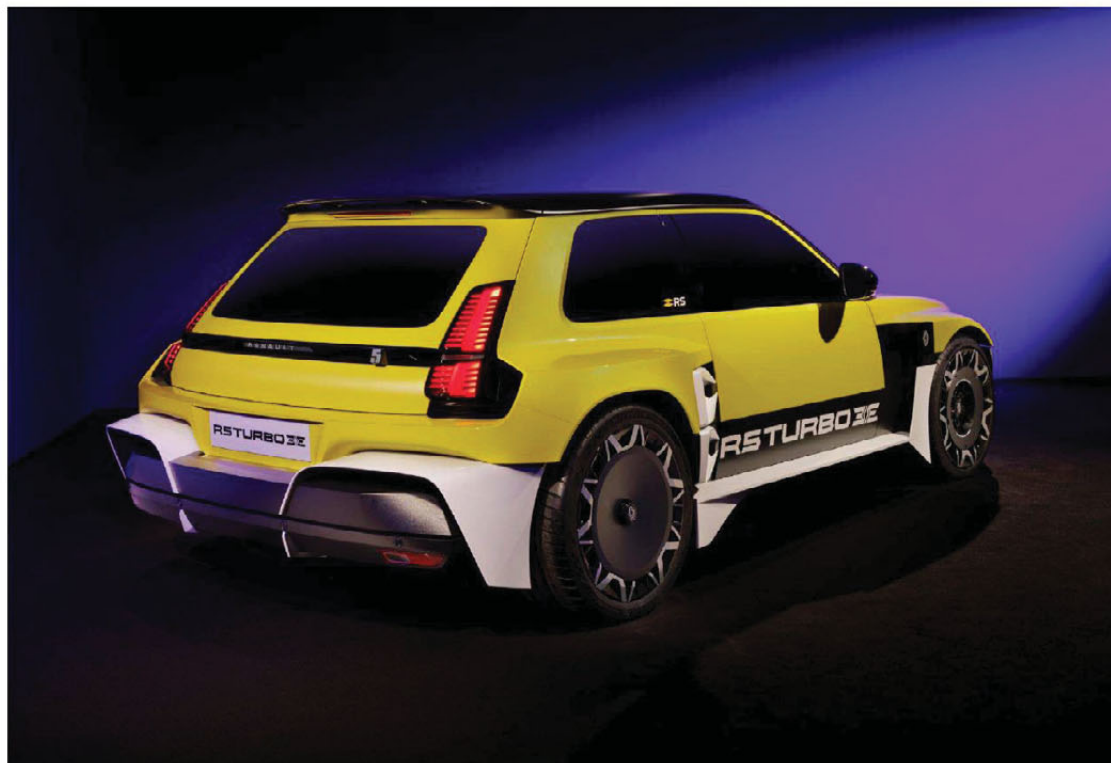
INGEN TURBO: Elektriske Renault 5 Turbo 3E har selvsagt hverken turbo eller turboforsinkelse. De to elmotorene leverer 540 hestekrefter fordelt på en 408 centimeters lang og 1450 kilo tung bil.
