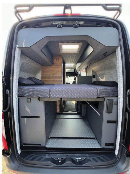
SENG: Tverrstilt seng med masse oppbevaringsplass under. Sengen er fordelt på to plater som kan vippes opp og festes til hver sin vegg på dagtid.
