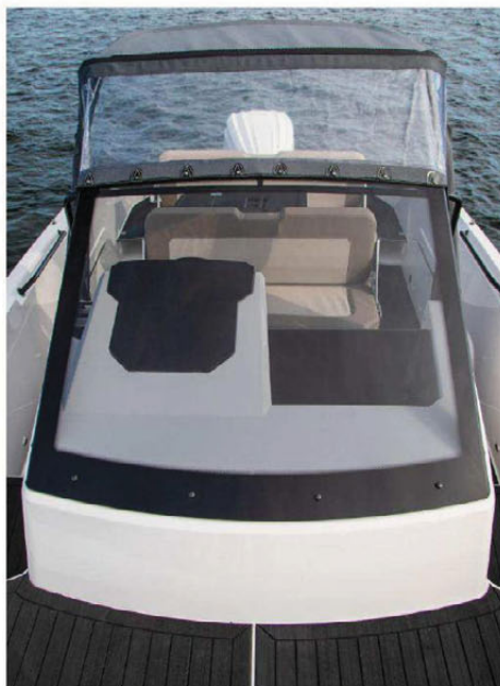
BESKYTTET: Sprayhood gjør førerplassen mindre utsatt for vind og nedbør.
