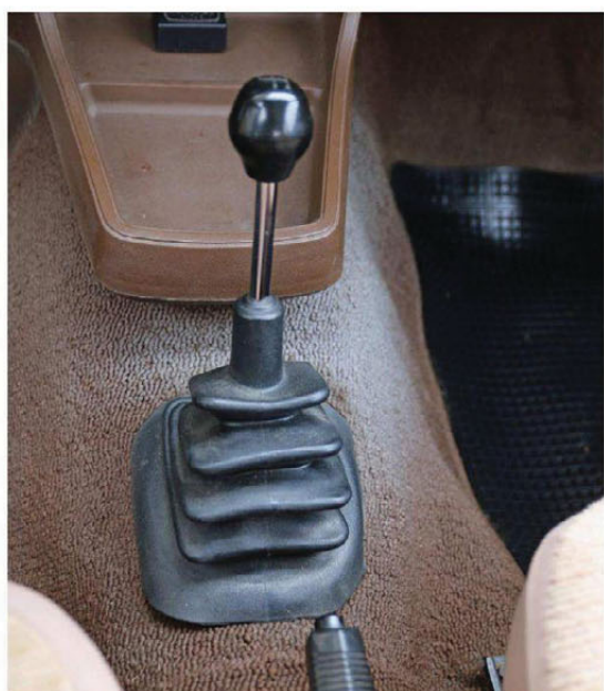
KORT SPAK: Firetrinns gir- kasse med kort spak.
