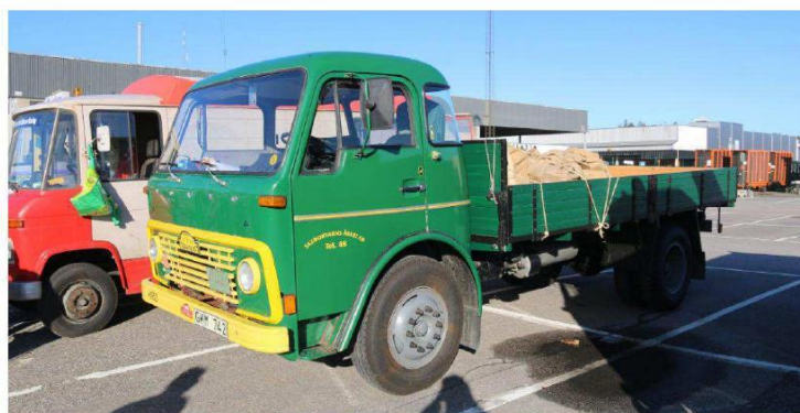
TipTop: 1963 Volvo L4751 Raske Tiptop (Kjempe i Norge) var Europas første lastebil med tippbart førerhus, skal vi tro Volvo. Det er ikke helt sant. Britiske Foden lanserte tippbart førerhus noen måneder før Volvo.
