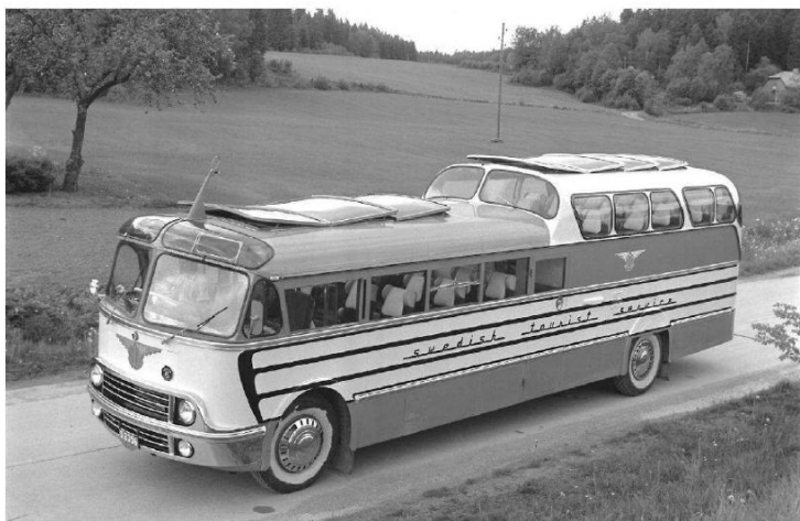
Buss med utsikt: En herlig turbuss tilhørende GDG Biltrafik AB, som klart er inspirert av amerikanske turvogner med utsikt. Den er bygget av Arvika Karosfabrik og er en 1953 Scania-Vabis B83. Den har åttesyndret motor, og vi regner med at det er samme rekkeåtter som ble brukt i Scania-Vabis Metropol? Det skal visstnok ha blitt bygget en serie på seks slike busser. En er bevart og eies av Helsingborgstrafikens Museiförening.
