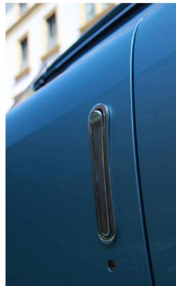
Innfelt: Italienske dørhåndtak hadde en egen stil på denne tiden. Forsenket og utvippbare.
