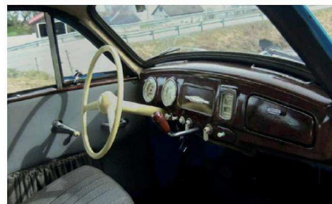
1955 I.F.A. F9 selges grunnet eigaens alder. Kjøpt som objekt i 1991, nedplukket og totalrestaurert og registrert på dagens eiger i 1996 med det originale reg. nummeret. Rammeløftet, all rust fjernet, nytt interiør. Styling og gearkasse overhaldt. Motoren overhaldt på Farstad Motorservice Molde. Framstår i dag som en meget pen og driftssikker kosebil. Det følger også med en masse brukte mekaniske deler. Selges helst til en som vil bevare den i originalstand. Tlf. 988 47 311
