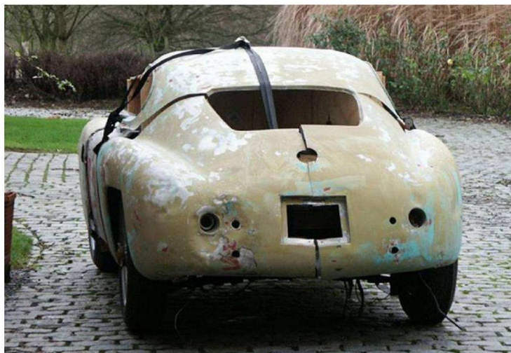
Delt i fire: Slik så bilen ut da den ble funnet i California i elendig stand. Ikke bare var den demontert, men karosseriet var også kappet på langs og på tvers. Vi snakker altså om fire deler.
