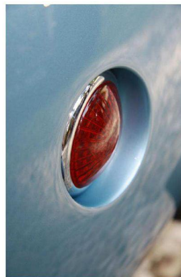
Glatt: Designen ble gjort glatt, ikke bare med skjulte lykter foran, men også forsenkede bak.
