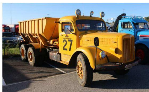
Flyplassbil: 1957 Scania-Vabis LS71 Regent med strøggregat for bruk på flyplasser.
