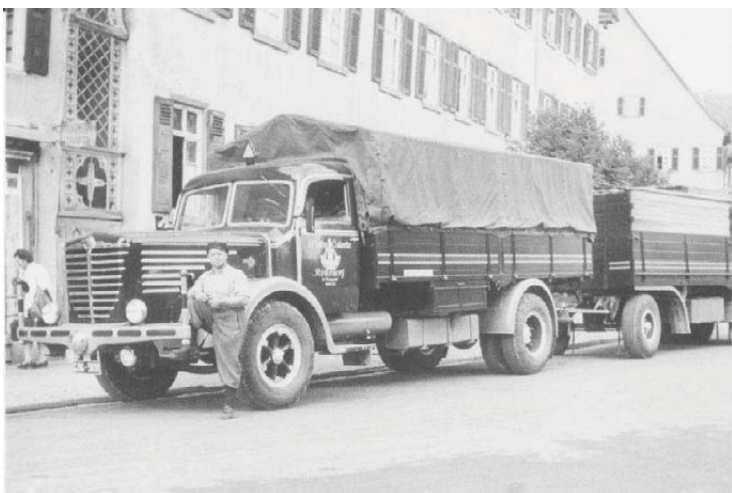
Stolt sjåfør: Büssing 8000 S med Wackenhut-karosseri og 3-akslet tilhenger, en svært foretrukket langtransportbil på slutten av femtitallet.
