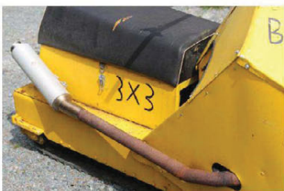
Barsk 3x3: En svenske bosatt på Oppdal bygde denne snøscooteren med Rotax-motor og drift på alle tre beltene. Det ble med denne ene som Oppdal Gammelteknisk Forening har tatt vare på.
