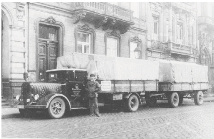
Vintertid: Stolt viser sjåføren av denne Mercedes-Benz L 5000 (nyttelast 5 tonn, 6 syl., 120 hk) frem det tildekkede motorpanseret som beskytter mot kulden.
