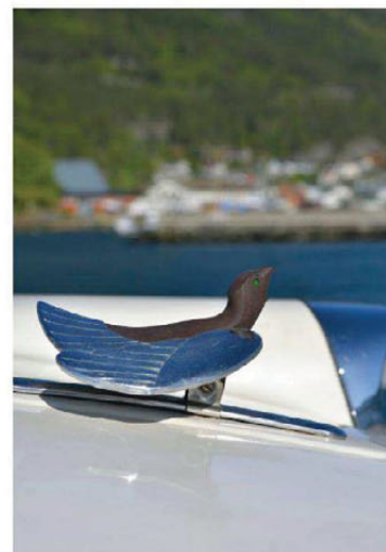
Iherdig fugl: Fuglen på panseret skal visstnok hjelpe til med å måke regn, støv og skitt opp og forbi frontruten. Odd Svendsen mener det gamle patentet fungerer ennå.
