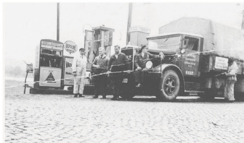
Klar for tyngre lass: Sjåføren (med sjæførlue) sitter på støtfangeren til en MAN F2/H6 fra 1935 (6 tonn, 6 syl., 100 hk) med Wackenhutkarosseri.
