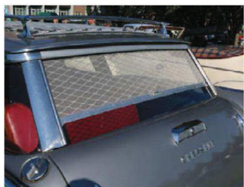
Fluenetting: Smart løsning for å få inn luft uten at insektene følger med.
