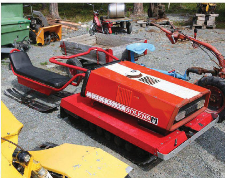
Sjelden: Bolens Diablo Rouge er en amerikansk snøscooter med en litt annen konstruksjon enn vanlig. Her er motor og belteaggregat foran, mens sitteplassen er på en «tilhenger bak». God framkommelighet og liten svingradius var blant fordelene.
