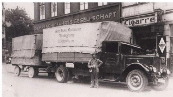
Ankomst ved et rederi: En Krupp med Junkers-motor klar for lossing. Påbygg og tilhenger er produsert av Wackenhut.
