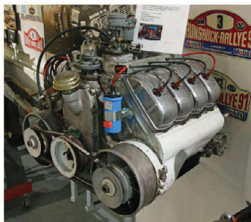
Luftkjølt: Tatras legendariske luftkjølte V8-motor.
