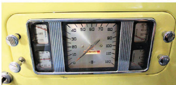
Info-sentralen: Alle instrumentene var ødelagt. Speedometer med km-skala kommer fra en annen norsk D-2 som er ombygd med uoriginale instrumenter. De andre instrumentene ble skaffet fra USA.
