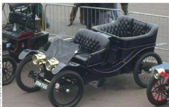
Høyst original: Kvalitetsmerket Lanchesters første seriemodell var en 10 HP med «absolutt midtmotor» mellom for- og bakseteavdelingen, og var stinn av spesielle finesser. Bildet vider den noe sterkere 12HP fra 1901.
