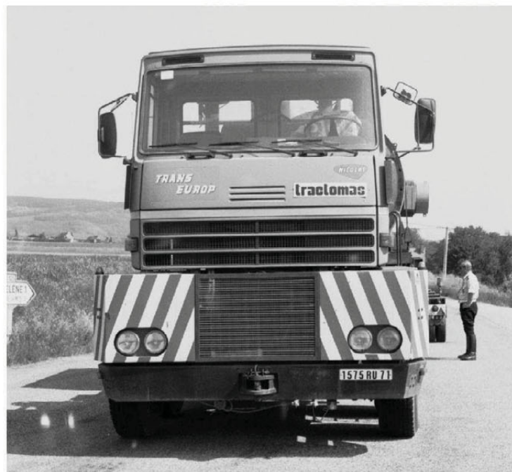
Dimensjoner: 3 meter bred og 3,5 meter høy. Nicolas Tractomas er utstyrt med en Daimler-Benz V 12 med 525 hestekrefter og momentforsterker.
