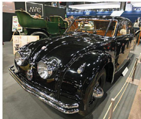
Hekkmotor: I 1934 sjokkerte man en hel verden med denne modellen, en Tatra T 77 med en luftkjølt V8-motor montert i hekken på en særdeles strømlinjeformet bil med bl.a. selv bærende karosseri over en sentralramme.
