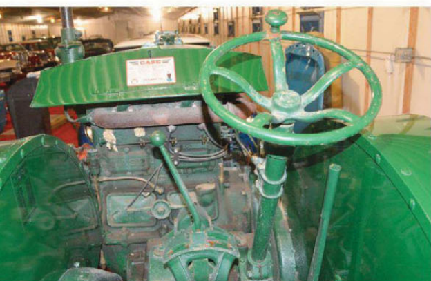
Synlig: Fra førerplassen har vi en god oversikt over den tverrstilte motoren.
