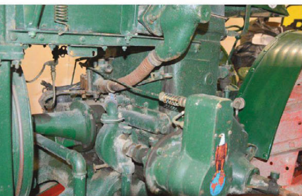
På tvers: Case 10-18 har en tverrstilt rek-kemotor som drivkraft.
