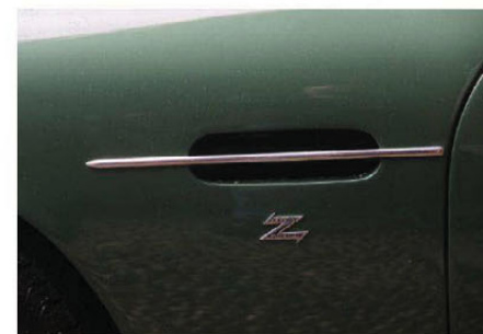
Designventil: Åpningene i forskjermene var nok mer for utseende skyld enn at de hadde særlig lufteeffekt.
