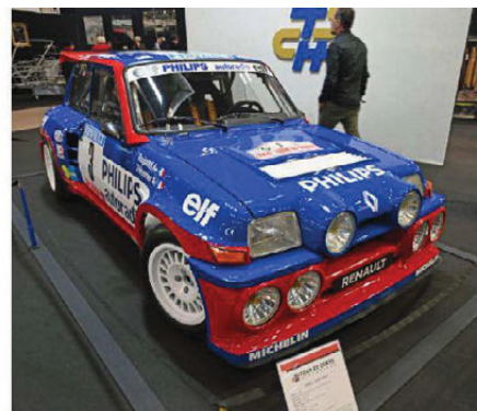
Tøff stålmus: 1985 Renault 5 Maxi Turbo, en vass bil med motoren montert i lengderetningen rett bak forsetene.
