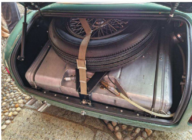
Langdistanse: En ekstra stor bensintank var utmerket på langtur, men ikke greit ved påkjørsel bakfra.
