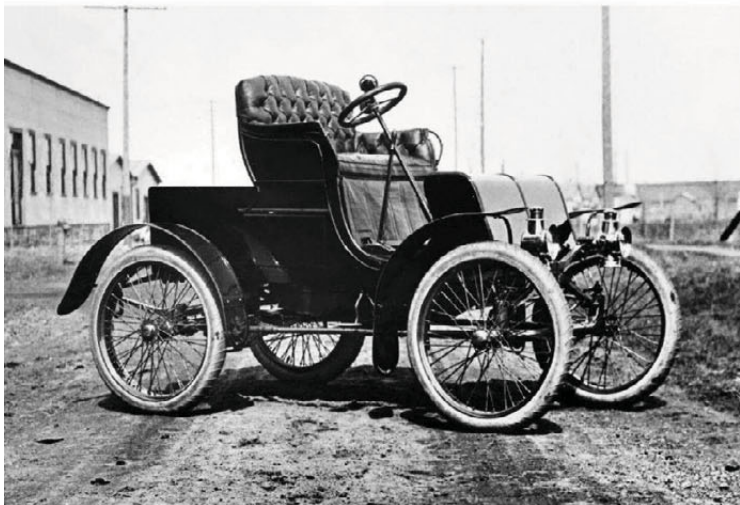
I forkant: Mens Packards Model B kun var en lett forbedret A, ble Model C (bildet) en av USAs mest moderne biler med relativt kraftig motor og ratt.
