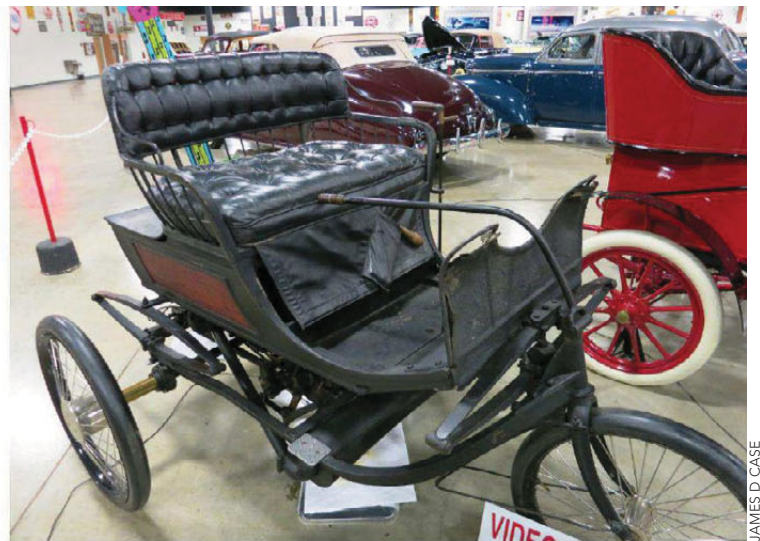
Pigg piggemotor: Den første Knox var trehjul med en luftkjølt motor som istedenfor finner hadde 1750(!) tynne metallpinner skrudd inn i sylindren for kjøling. På folkemunne ble motoren bare kalt «pinnsvinmotor».
