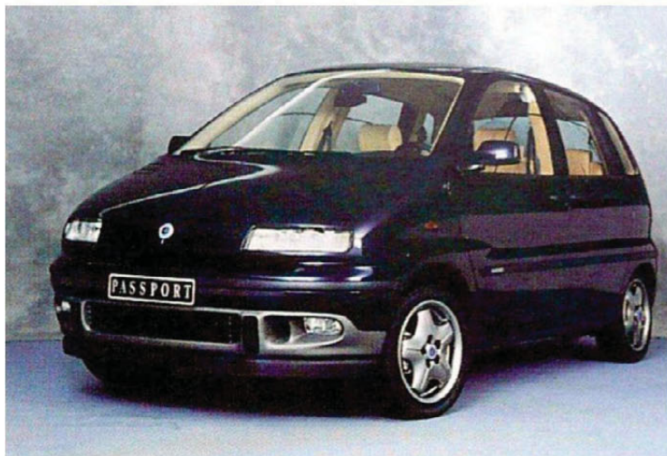
Vass flerbruksbil: Hobbicar Passport med 2-liter på 207 hk og all-hjulsdrift. Teknikken kom fra Opel Vectra.
