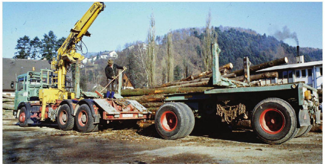
Børster: Rengjøring av rester fra lasten før lasting av tilhengeren opp på lastebilen ved hjelp av vinsjen.
