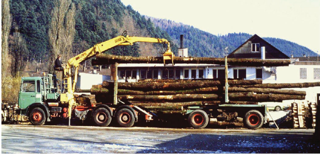
Av med tømmeret: Lossing av middels lange stokker.
