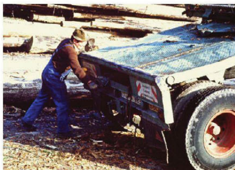
Samarbeid: Mens Franz håndterer vinsjen for å trekke tilhengeren på lastebilen styrer Ludwig tilhengerens framaksel slik at den trekkes opp dit den skal.
