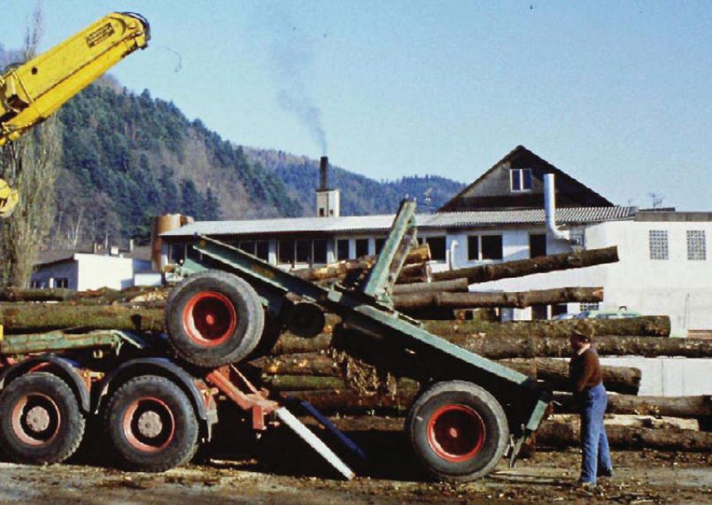
Presisjon: Franz aktiverer vinsjen, mens Ludwig styrer hengeren nøyaktig på plass med et ratt bak på hengeren.
