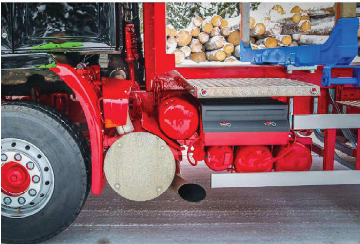
Detaljene avgjør: Lokket til batterikassa ser kanskje helt ordinært ut, men den vannrette pressingen over låsene er en tidsriktig detalj som ikke finnes på dagens nyproduserte lokk.
