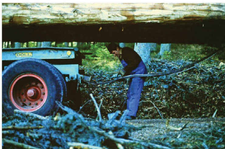
Navlestrengen: Avhengig av avstanden fra lastebilen til tilhengeren må strøm og luftslangene justeres og festes ved vinsjens stålwire, som forbinder begge kjøretøyene.
