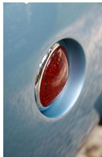
Glatt: Designen ble gjort glatt, ikke bare med skjulte lykter foran, men også forsenkede bak.
