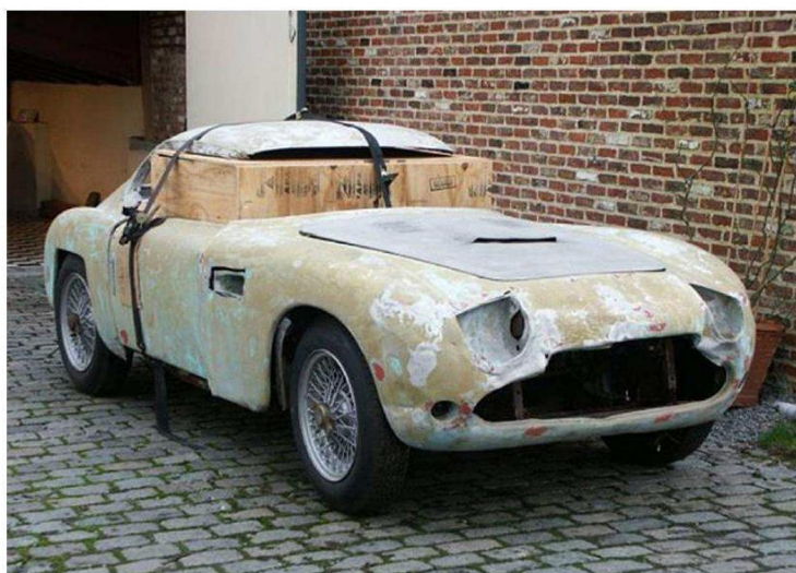
Ikke noe koffertlokk: Bagasje og reservehjul gikk gjennom dørene.
