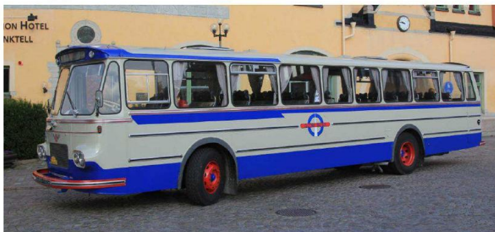
Turvogn: 1967 Scania-Vabis BF76 tilhørende Veteranbussgruppa Nettbuss Østfold. Bortsett fra en lakkering er bussen i urørt originalstand. Karosseriet kommer fra T. Knudsen.
