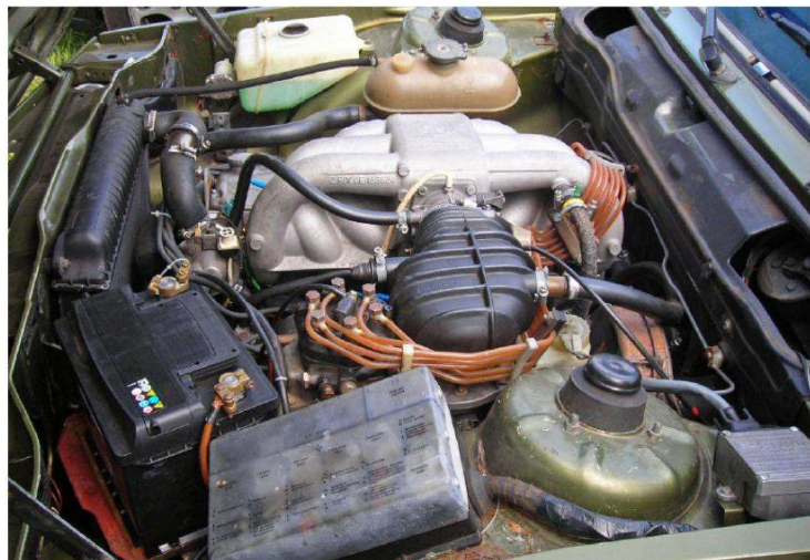
Sprut til tusen: Mekanisk innsprøyting fra Bosch gjør susen!
