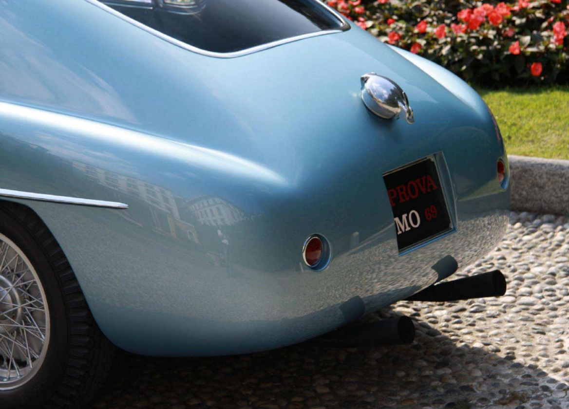
Ikke noe koffertlokk: Bagasje og reservehjul gikk gjennom dørene.
