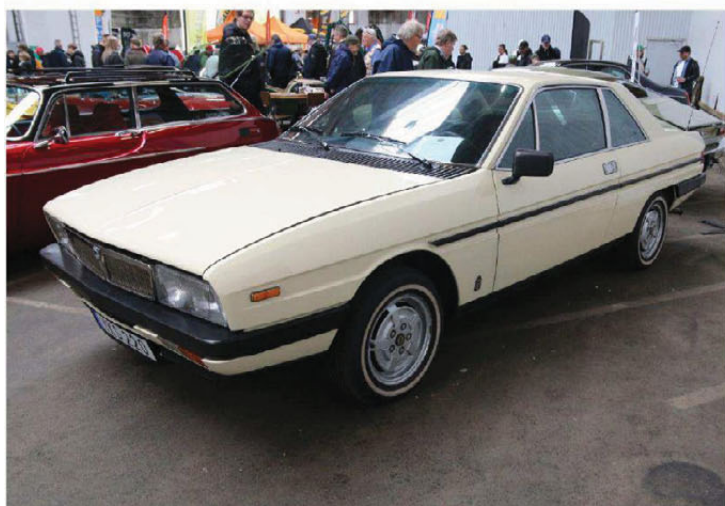
Boxer: Uvanlig Lancia Gamma Coupé utstyrt med en firesylindret boxermotor på 120 hk.
