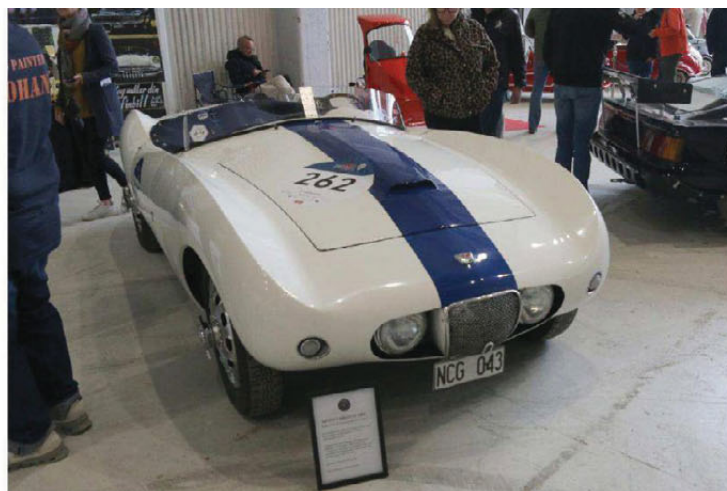
Rask: 1954 Arnolt-Bristol bygget av Carrozzeria Bertone i Italia. Motoren er en Bristol Bs1 MK II, sekssylindret med hemisfæriske forbrenningskammere og en effekt på 148 hk.
