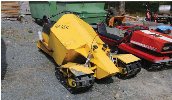
Barsk 3x3: En svenske bosatt på Oppdal bygde denne snøscooteren med Rotax-motor og drift på alle tre beltene. Det ble med denne ene som Oppdal Gammelteknisk Forening har tatt vare på.
