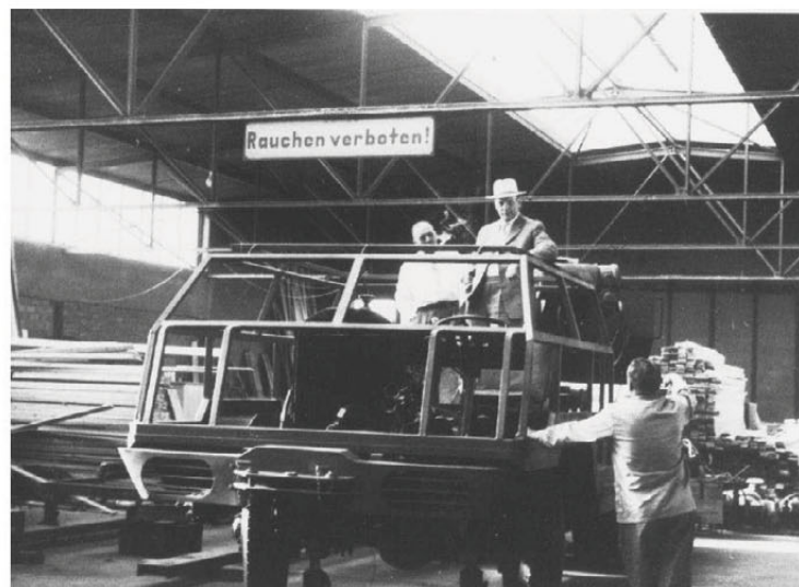
Ideell for berging: En Pacific tanktransporter der Ernst Wackenhut (med hatt) kontrollerte det hele, ble modifisert til en bergingsbil for å bringe skadede kjøretøy til verkstedet.
