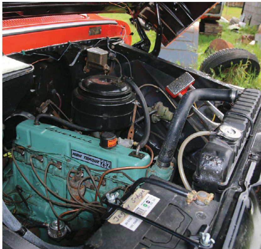
Sterk sekser: 292 cid og 165 hestekrefter.
