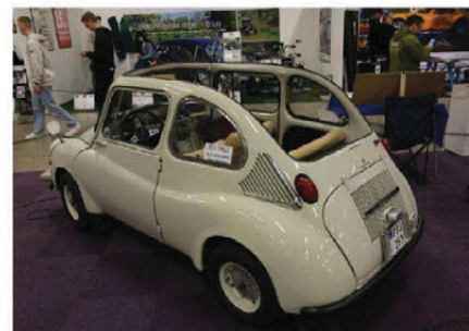
Debutanten: Subaru 360 var den første masseproduserte bilen fra selskapet. Den var utstyrt med en luftavkjølt to-sylindret rekkemotor på 356 cm 3 . Modellen var i produksjon fra 1958 til 1971 og totalt rullet det ut 392 000 biler fra fabrikk.
