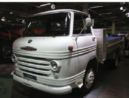
Nyttig med V8: World of Volvo stilte med stor stand og fine biler. For eksempel denne 1965 Volvo L 430 Trygge med Volvos egen V8-motor på 3,6 liter og 120 hk. En vanlig misoppfatning er at motoren er basert på to Volvo B18-motorer, men det stemmer ikke. Motoren, med betegnelsen B8B, ble tatt frem allerede 1952/53 og var opprinnelig tenkt for personbilen Philip, men den ble kun bygget i ett eksemplar. Motoren ble så videreutviklet og fant veien til lastebilmodellene Snabbe og Trygge, samt som båtmotor.
