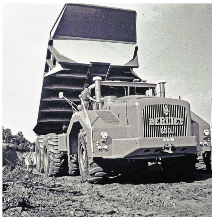
Voksen tippbil! T 100 No. 3 var utstyrt med et tippåbygg fra Bennes Marrel, og ble brukt i fem år i en fransk urangruve.
