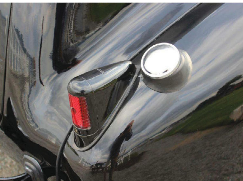
Detaljer: 1937 var siste år med synlig tanklokk. På 1938-modellen ble påfyllingen flyttet til venstre side og skjult bak en luke. Forholdsvis beskjedne baklykter på en så stor bil.
