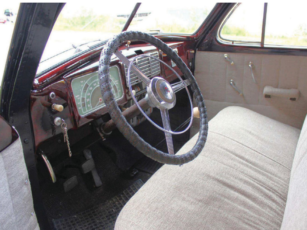
Tiltalende dashbord: Stort og tydelig kombiinstrument. Klokke i hanskeromslokket var standard, mens blank hornring var ekstraustyr på Special.
