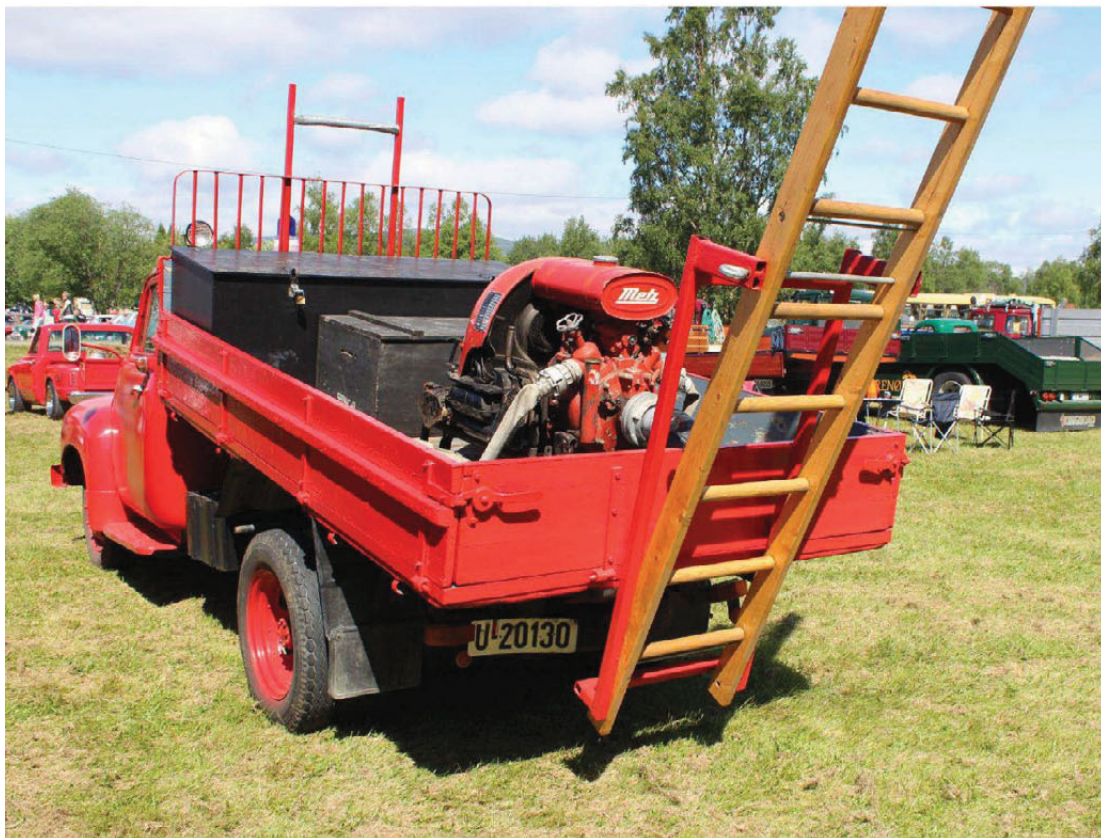
Enkel brannbil: Stige, pumpe og utstyr er på plass på U-20130, som i prinsippet er en vanlig lastebil.
