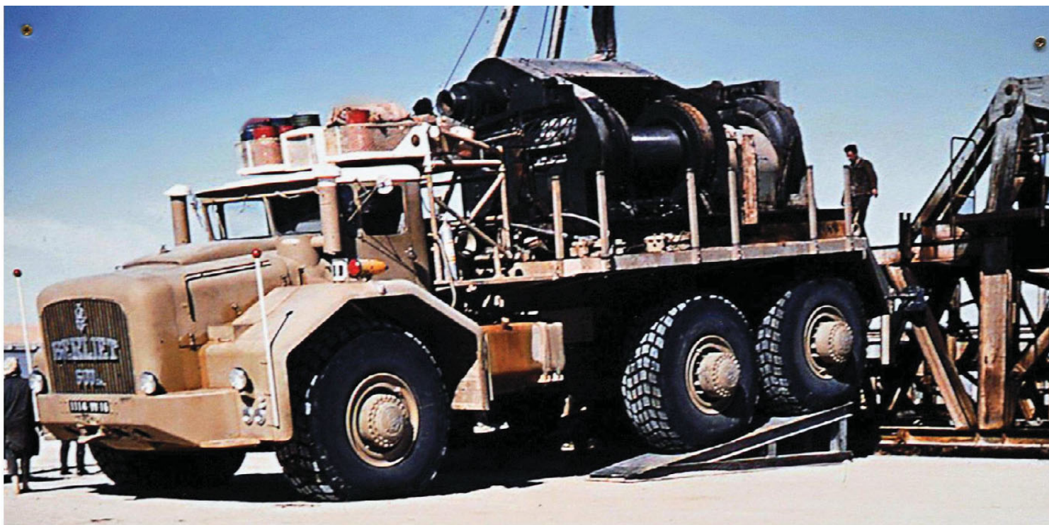
Designet for stor og bred last: T 100 med flakpåbygg og kraftig vinsj laster udelbart gods for geologiske undersøkelser i Sahara.
