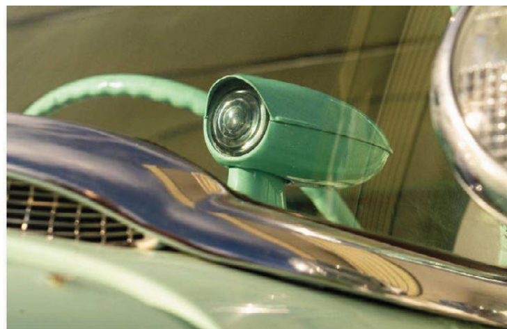
Automatikk: Det ser kanskje ut som en blanding mellom UFO og kjøkkenmaskin. Men Cadillac Autronic-Eye var en lyssensor som automatisk dimmet langlysene.
