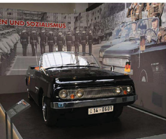
Par, tre stykker: Sachsenring P 240 Repräsentant ble bygget i 1969 for militærparader av VEB Sachsenring (VEB = Volks-Eigener Betrieb / Folkets Egen Bedrift) sin prototypeavdeling. Den har et polyesterharpiks-karosseri på en chassissamme fra en P 240 med en 6-sylindret motor på 2.407 cm 3 som gir 80 HK. En radioinstallasjon med uavhengig krets med batterier var for å holde taler.
