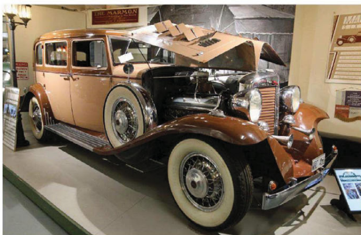
Luksus: 1933 Marmon Sixteen type 140 er utstyrt med en topp-ventilert V16-motor på 200 hk
