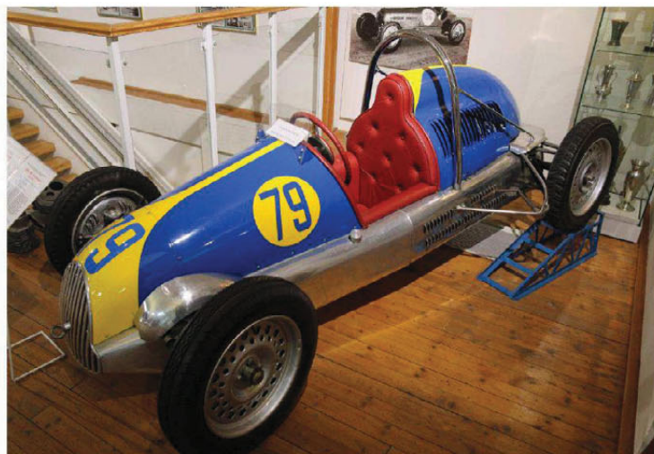
Midget-racer: Effyh 500 utstyrt med en JAP-motor på 500 cm 3 og 42 hk, toppfart 180 km/t. Det ble bygd en serie på 56 biler mellom 1947 og 1952.
