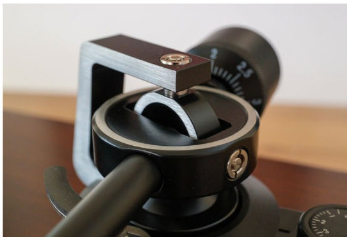
Enkelt, men Duals firefeis oppheng fungerer godt, og vil gjøre ut spillerens levetid. (Foto: Lasse Svendsen)
