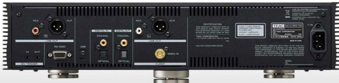
BNC-kontakten bak brukes sammen med en ekstern klokke, for å synkronisere klokkefrekvensen mellom to digitale enheter, og slik unngå jitterstøy. (Foto: Lasse Svendsen)
