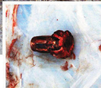
GJENNOMTRENGING: Etter å ha gått på skrå inn bak bog og ut i framkant av bog stoppa fint ekspandert 250 grs Barnes TTSX mot seigt bøffelskinn.
