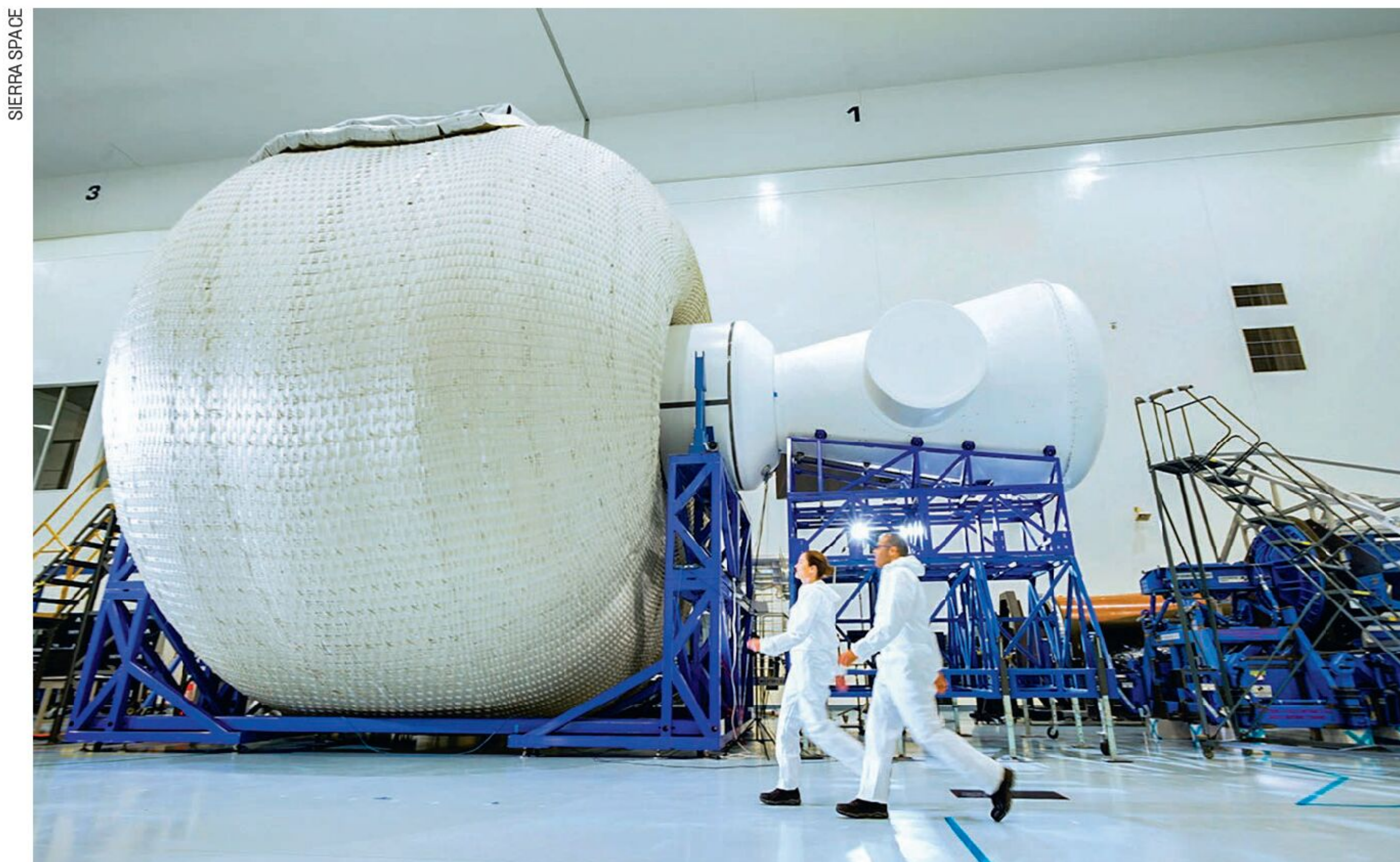
De oppblåsbare modulene kalt LIFE, som skal brukes på romstasjonen Orbital Reef, er laget av fibermaterialet vectran. Her blir en modul trykktestet av Sierra Space.
