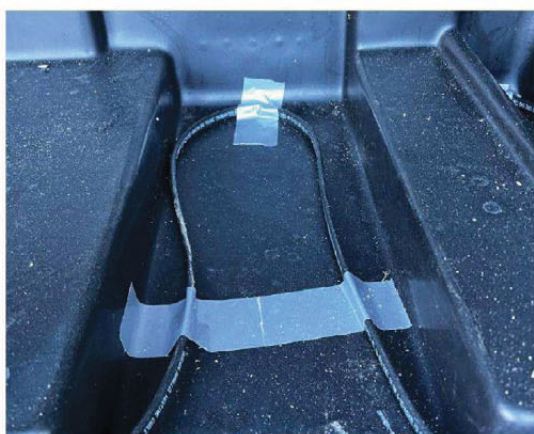
Fordamping: I bunnen av ytterkammeret ligger det en varmekabel. Den sørger for at sigevæsken fordampes, pluss at komposten får en bedre arbeidstemperatur når det er kaldt.
