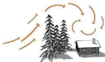
Omgivelser: Forhøyninger i terrenget, trær eller andre bygg kan lage turbulens som får luften til å slå ned i peisen.
