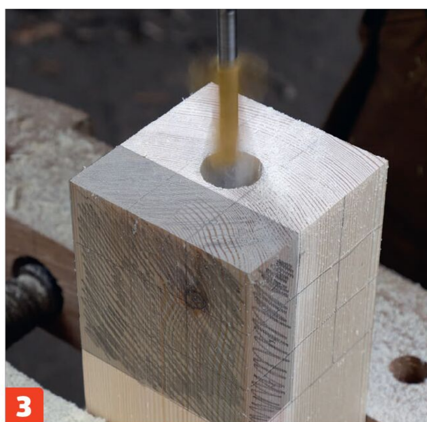
3 Begynn med å bore ut det midterste feltet. Bruk igjen spadeboret til å bore et hull i en dybde som tilsvarer 1/3 av dimensjonen på emnet.
