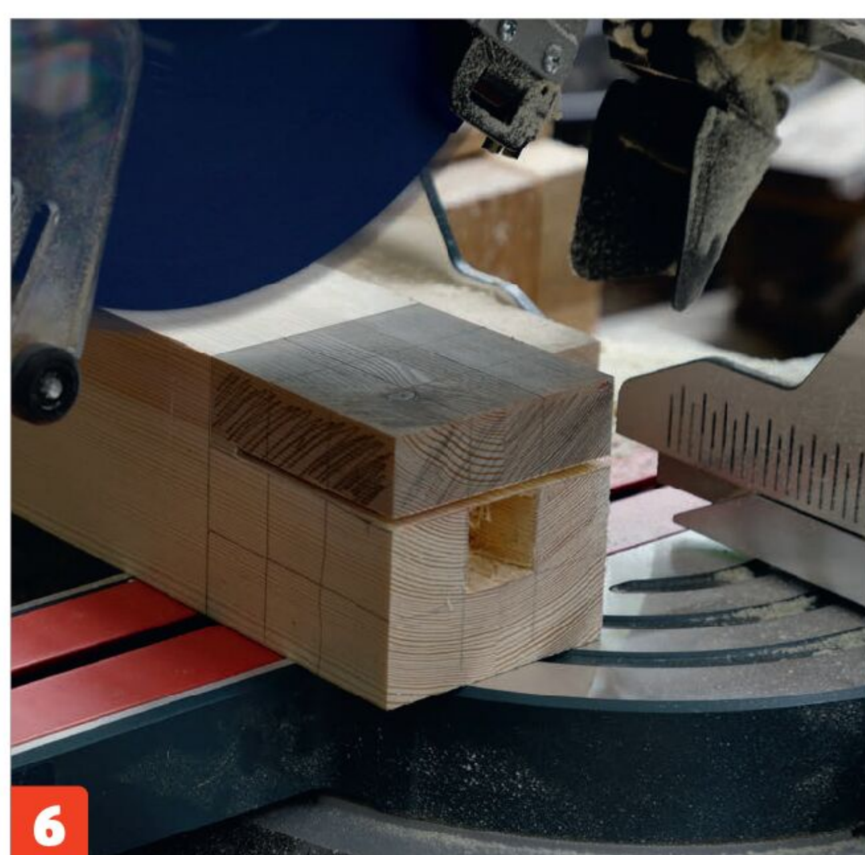
6 Sag det tverrgående snittet på kappsagen, der dybdestoppet fortsatt er stilt inn slik at du ikke kan sage dypere enn 1/3.
