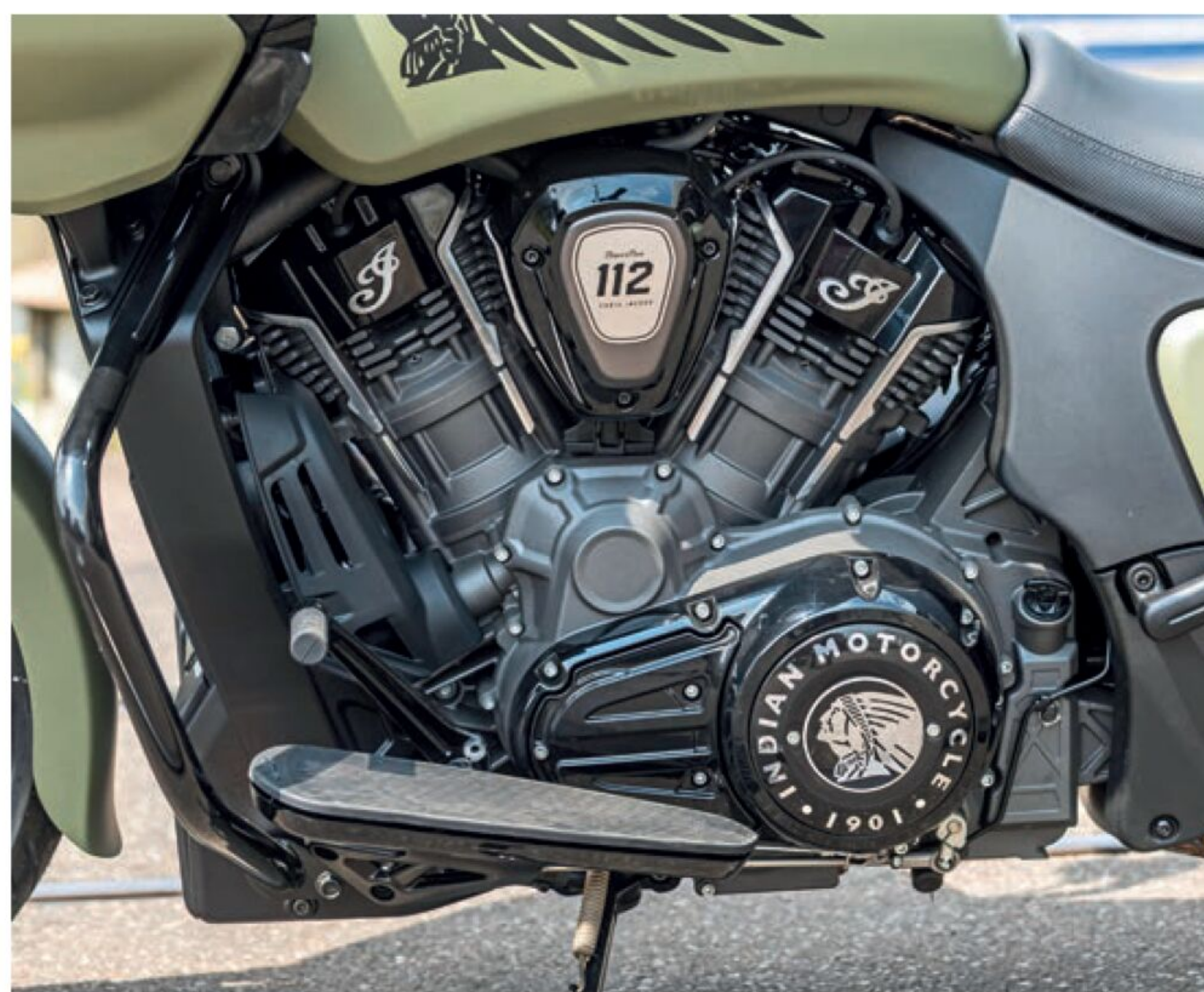
112 PowerPlus: 1 834 kubikk, 60 grader mellom DOHC-toppene, helt vannkjølt og med sylindravstengning.
