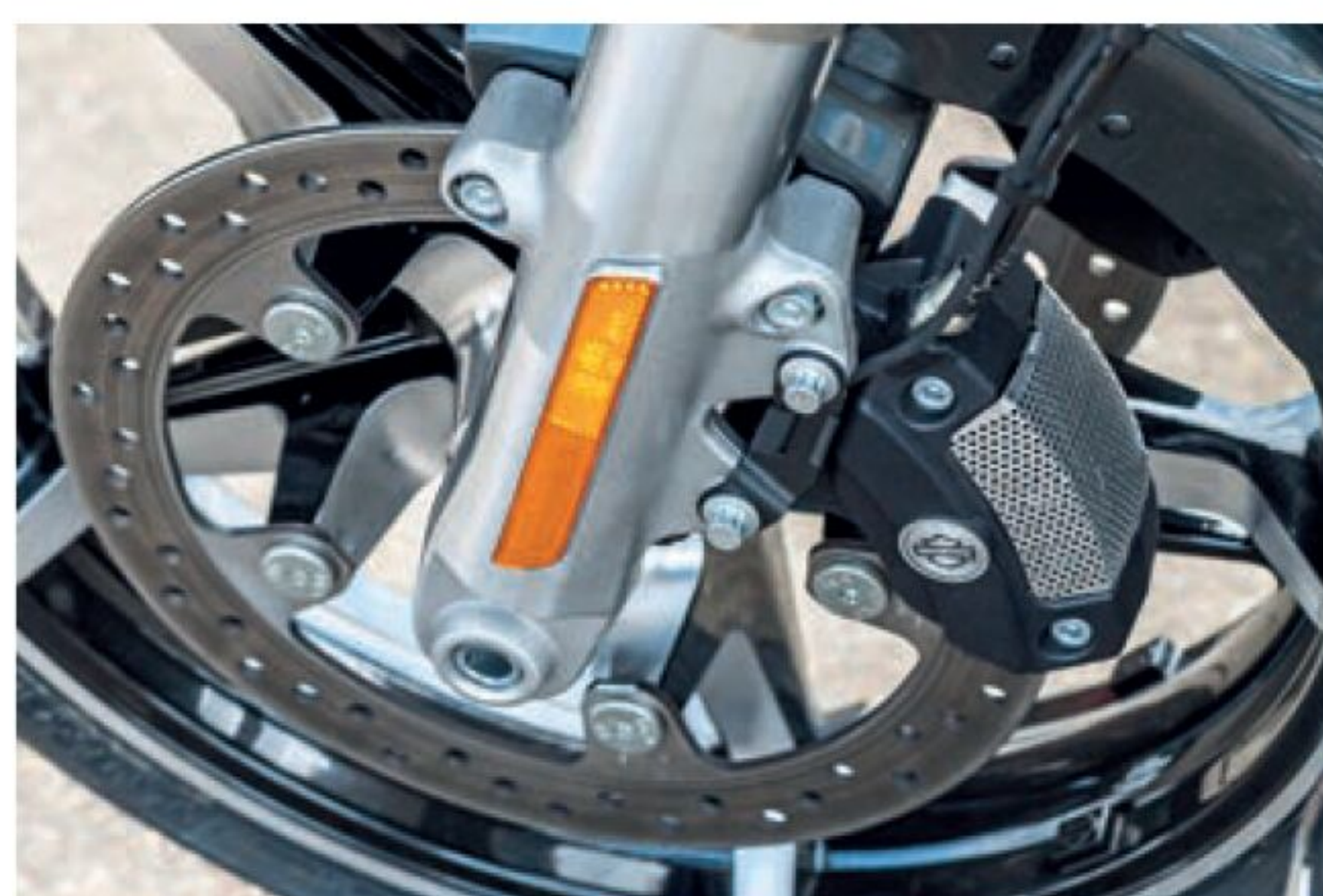
Aksialmonterte, firestemplede kalipere gir kraftig retardasjon og overraskende god dosering.
