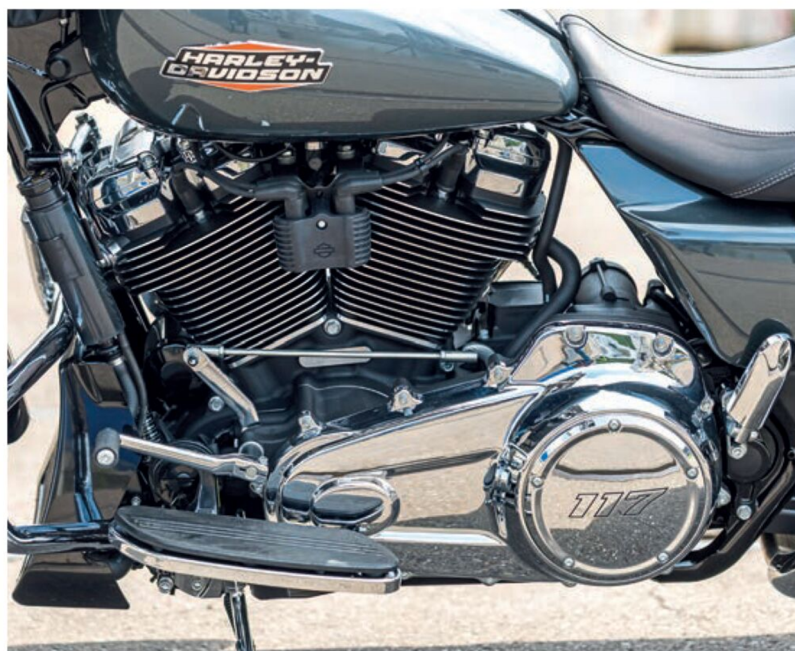
Milwaukee-Eight 117: 1 923 kubikk, 45-graders sylindervinkel, støtstenger, vannkjølte topplokk.
