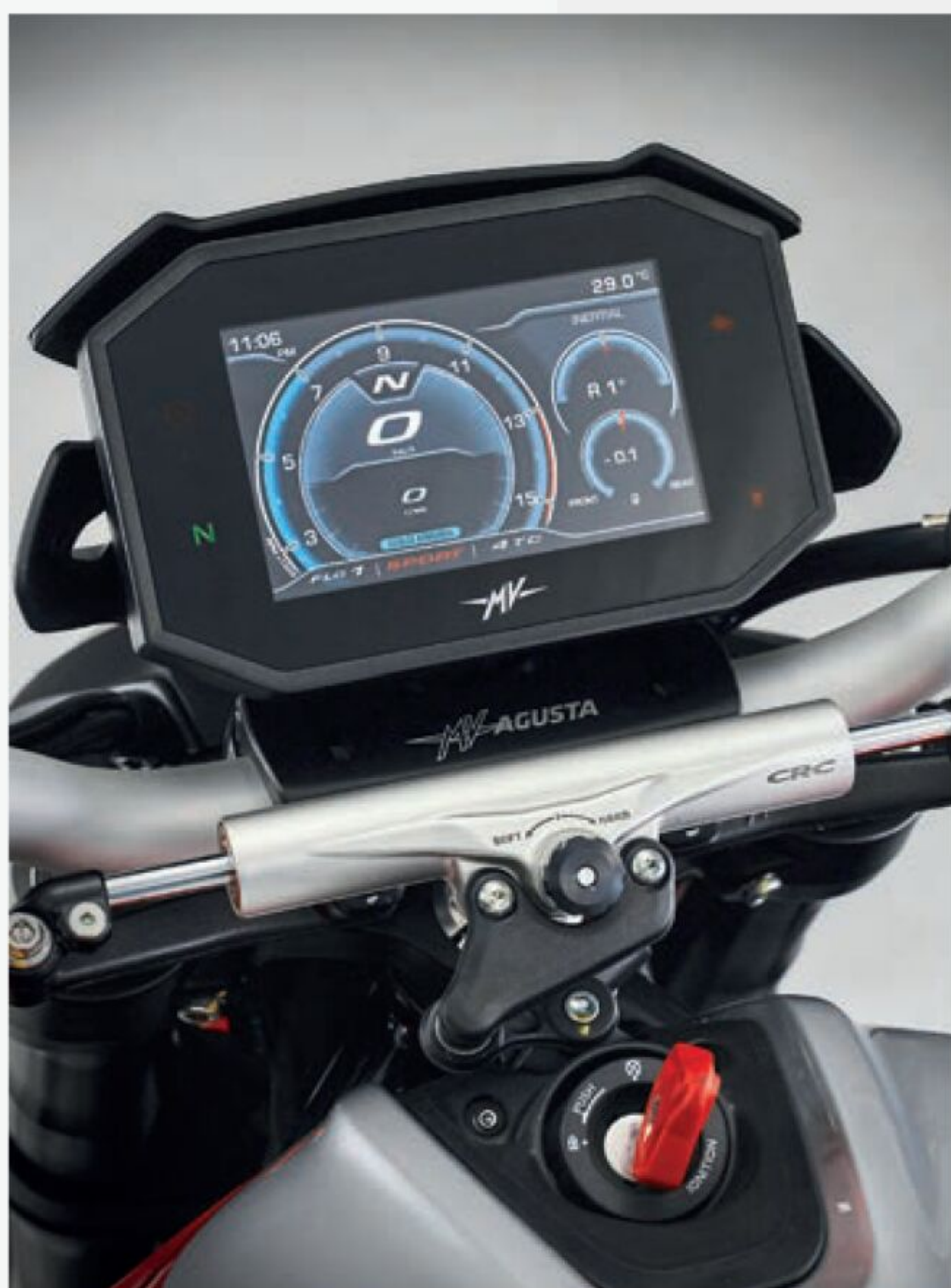
Den velstrukturerte instrumenteringen med intuitiv menynavigasjon mangler litt kontrast ved bakgrunnsbelysning, noe som svekker lesbarheten.
