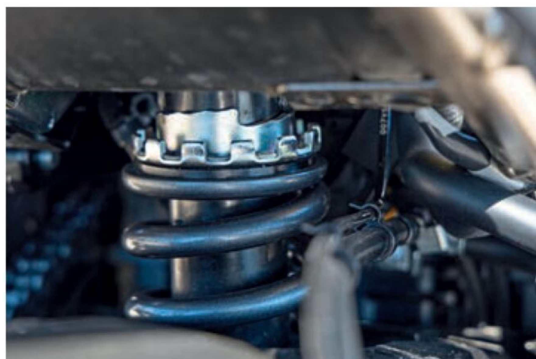
Å justere fjærforspenningen med en billig C-nøkkel kjennes gammeldags og er praktisk talt umulig.
