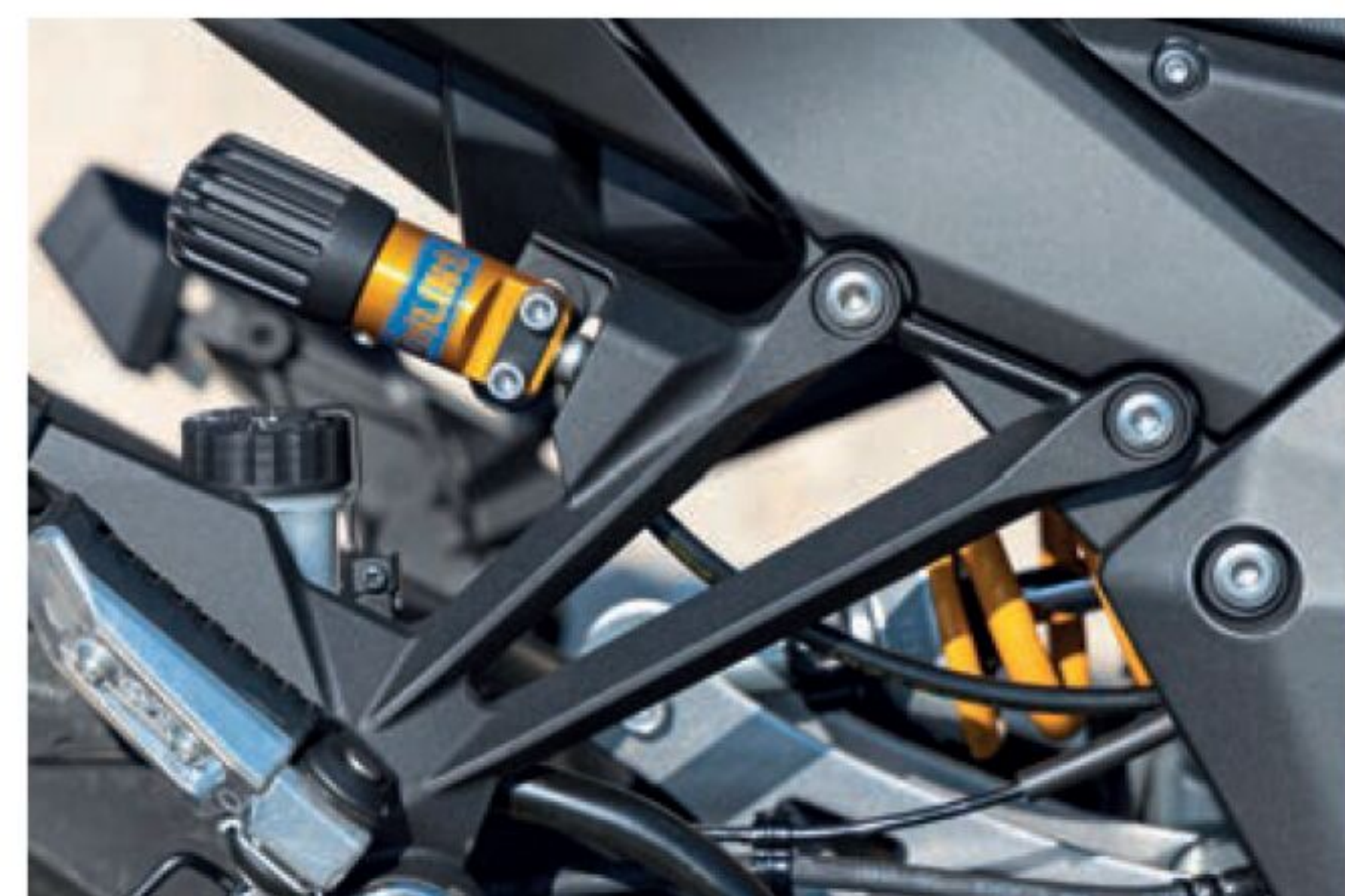
SE-versjonen har Öhlins S46 støtdempere med et lett tilgjengelig ratt for justering av forspennet.
