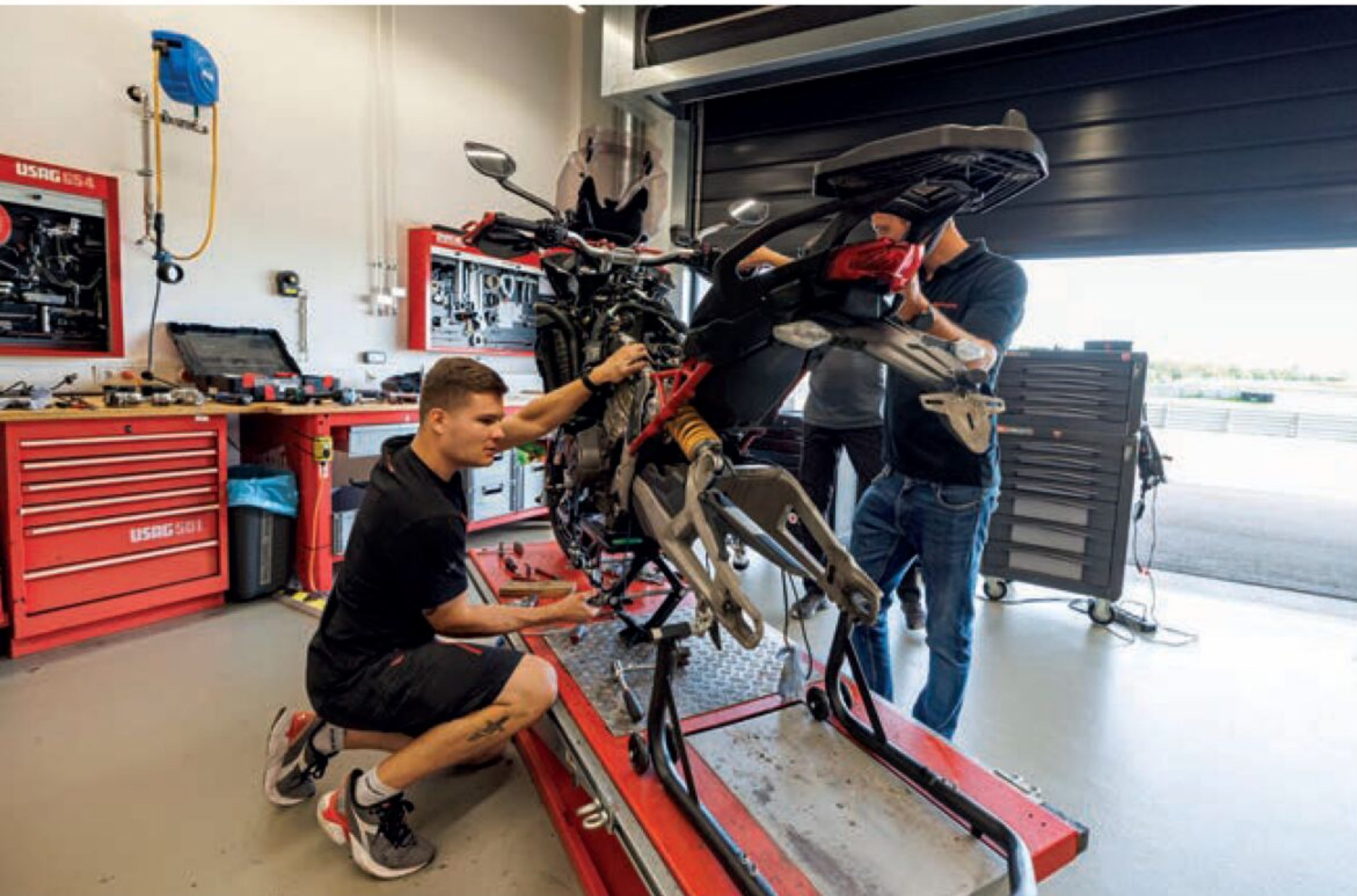
To erfarne mekanikere og en hel dags arbeid – det er ikke helt lett å skille Multistradas bærende motor fra resten av chassiset.
