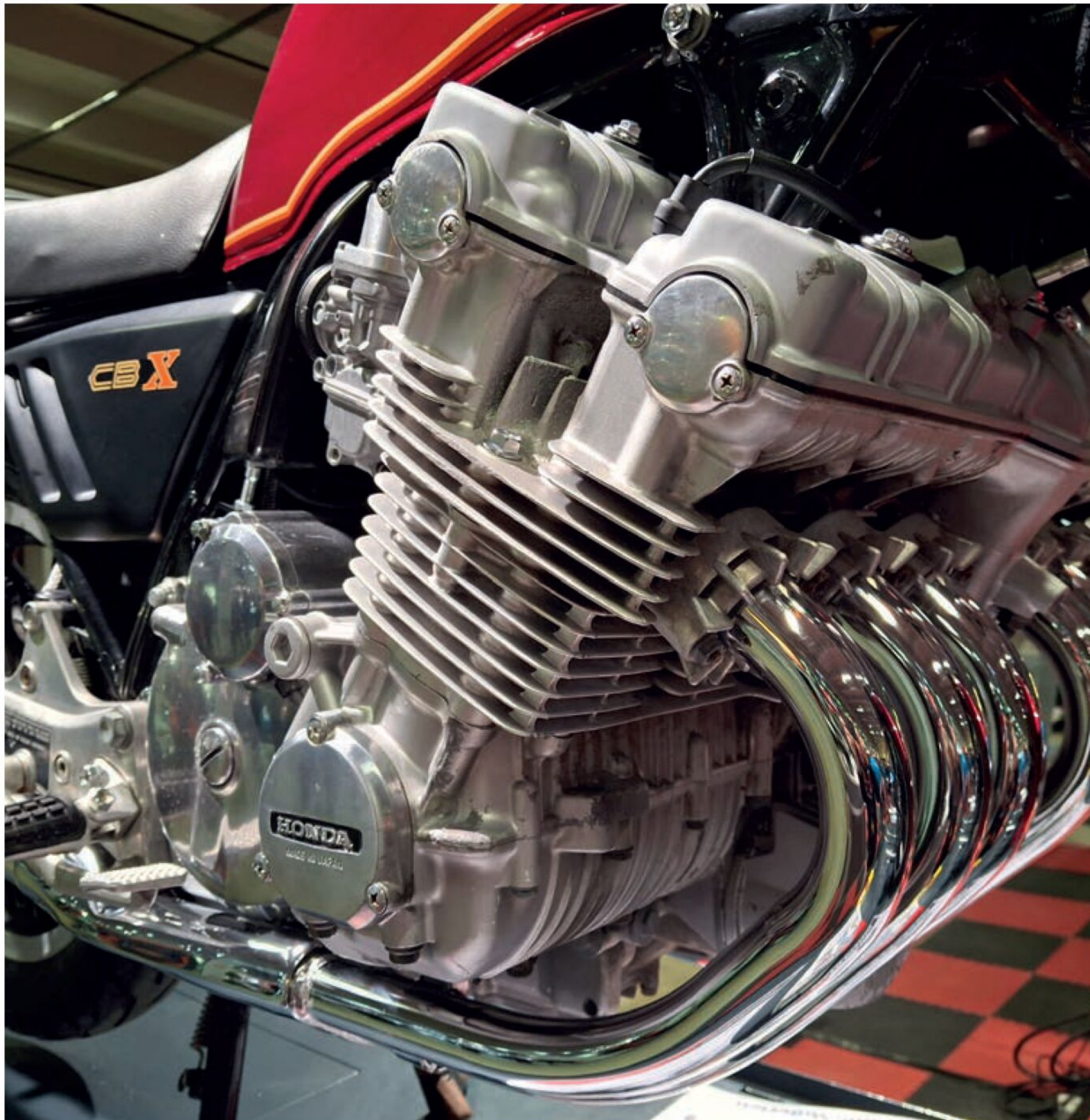
Den imponerende motoren til Honda CBX 1000 fanger oppmerksomheten til de fleste når et velholdt eksemplar dukker opp på Oslo Motor Show. 6 sylindere, 6 forgassere og 24 ventiler slår det meste.
