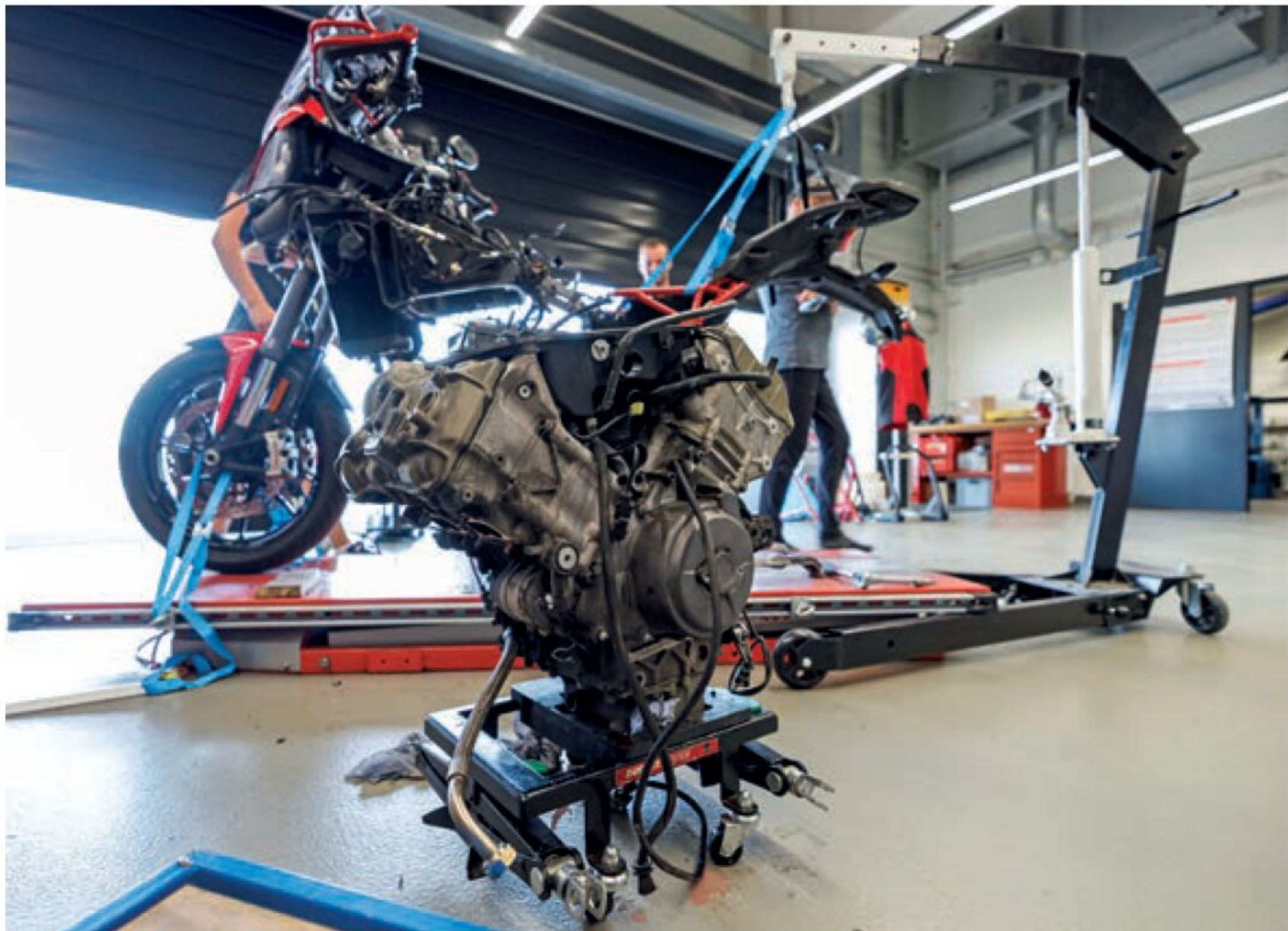
Etter demontering ble 90-graders V4-motoren nøye tatt fra hverandre, og hver enkelt del ble målt.
