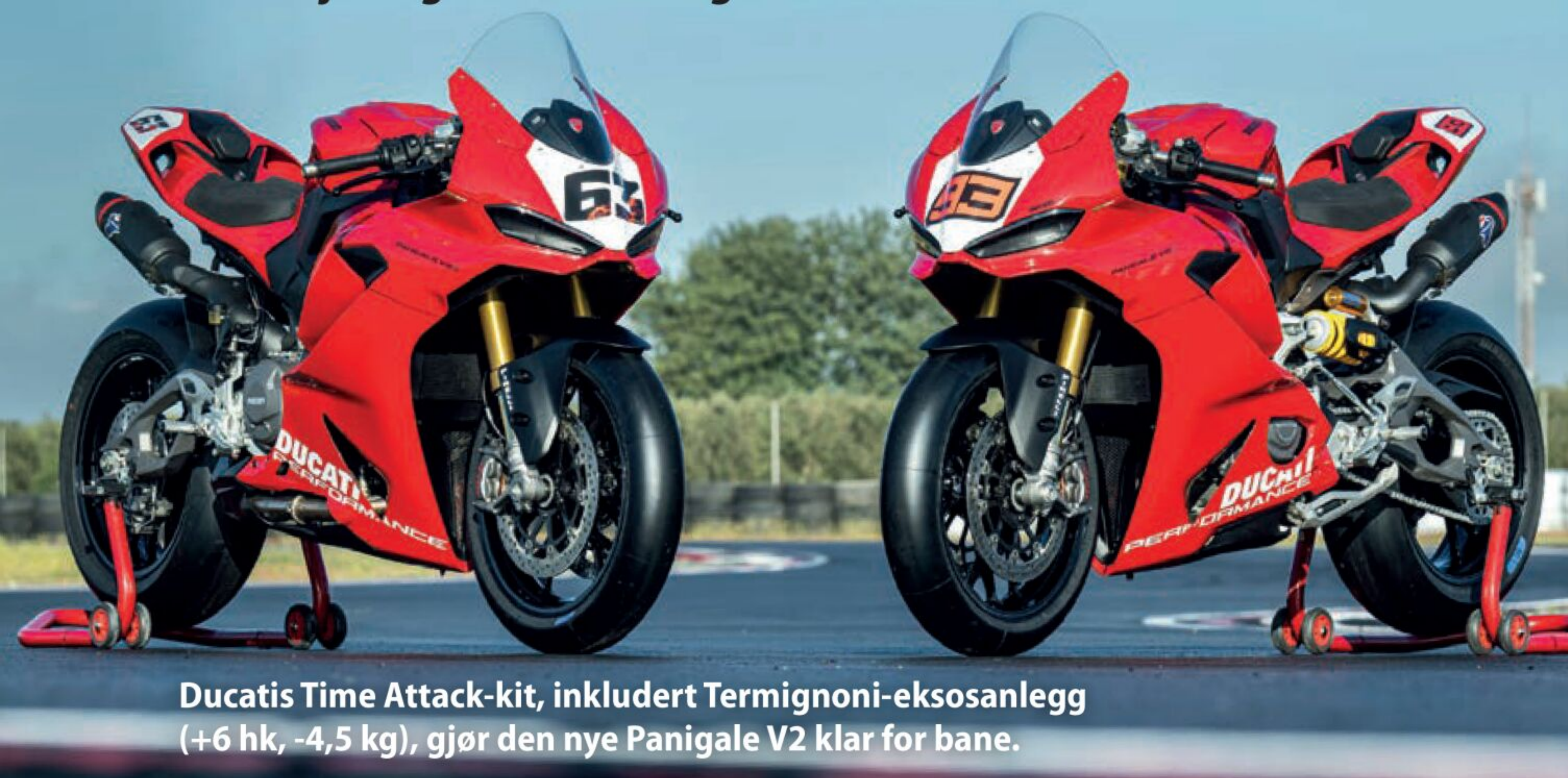
S-versjonen har fullt justerbar og godt avstemt Öhlins-fjæring foran og bak.
