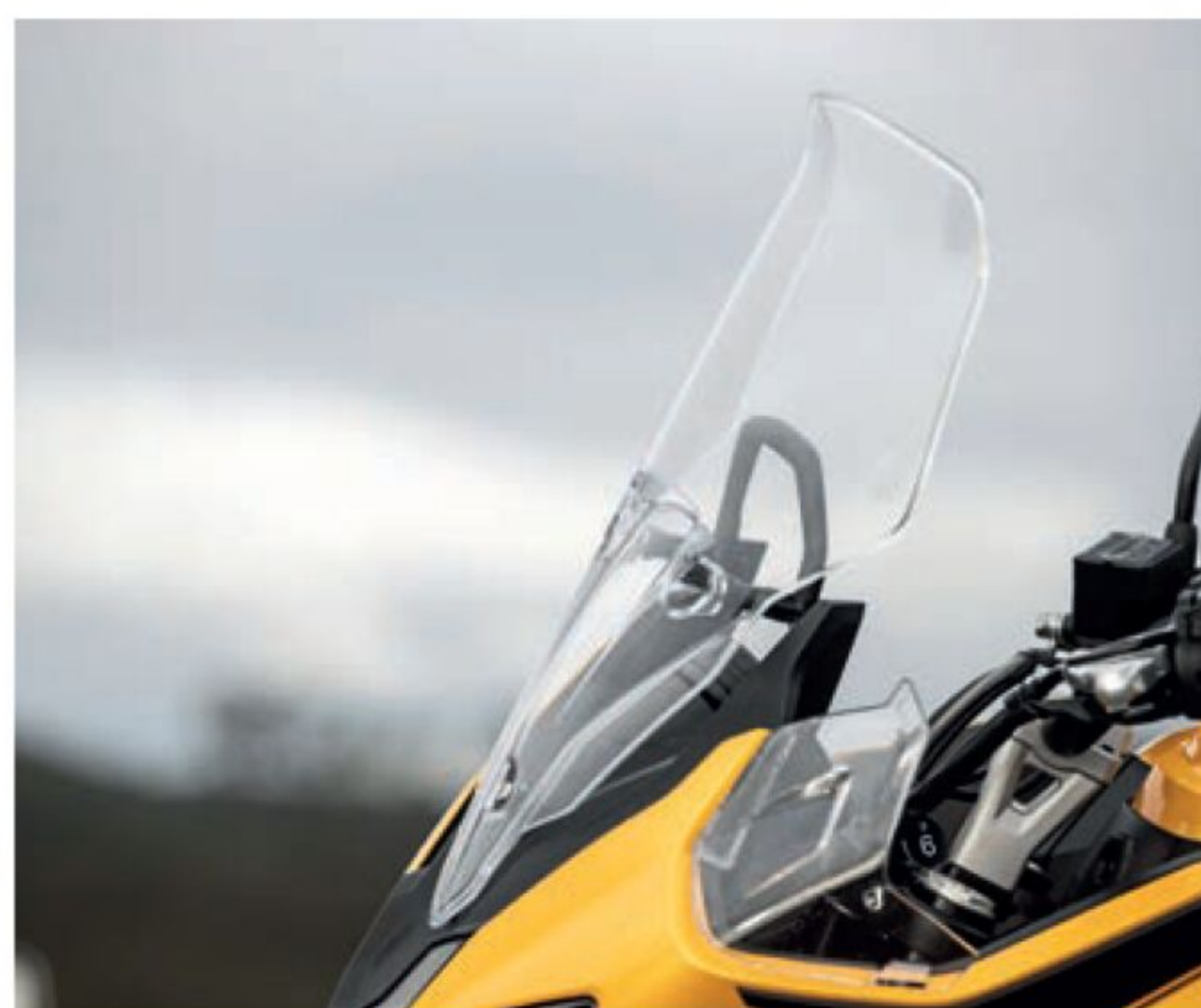
Høyden på vindskjermen kan justeres med én hånd. Sju posisjoner å velge mellom, men det bør helst gjøres stillestående.
