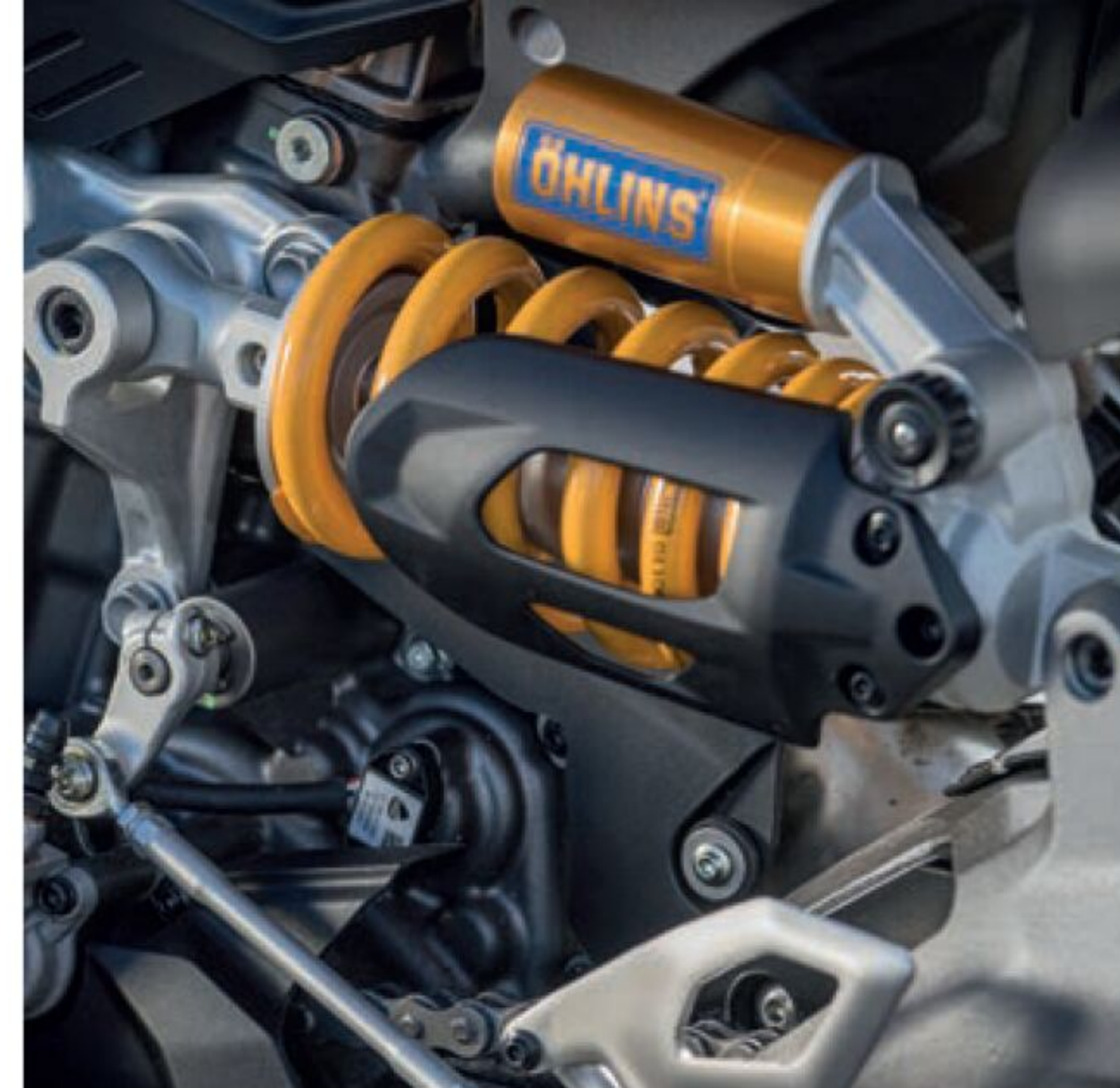
S-versjonen har fullt justerbar og godt avstemt Öhlins-fjæring foran og bak.
