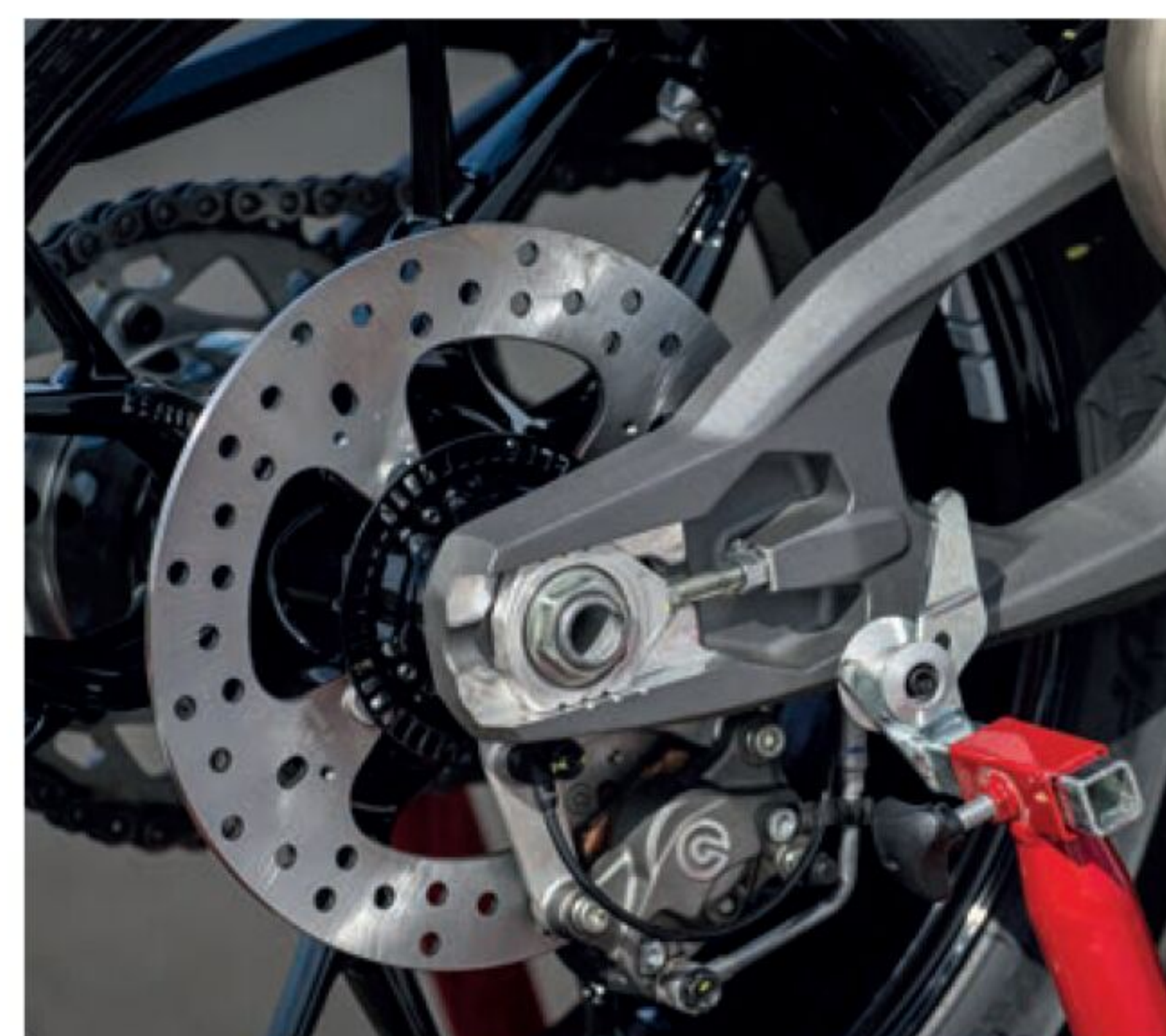
Monosvingarmen fra forgjengeren er erstattet av Ducatis lettere Hollow Structure svinggaffel, som gir føreren bedre tilbakemelding.
