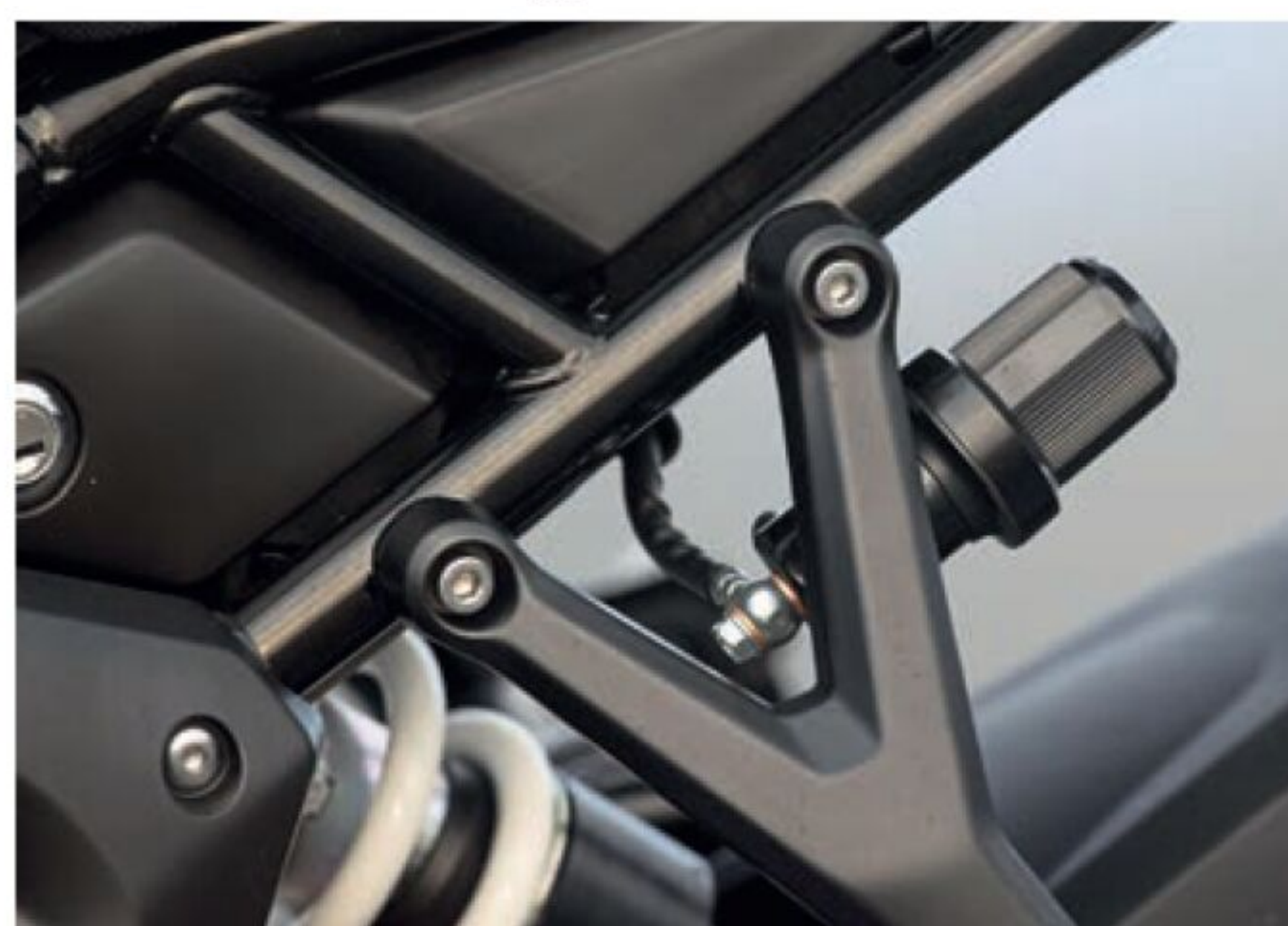
Bak kan du justere fjærforspenningen ved hjelp av et velplassert justeringshjul. All ære for det.
