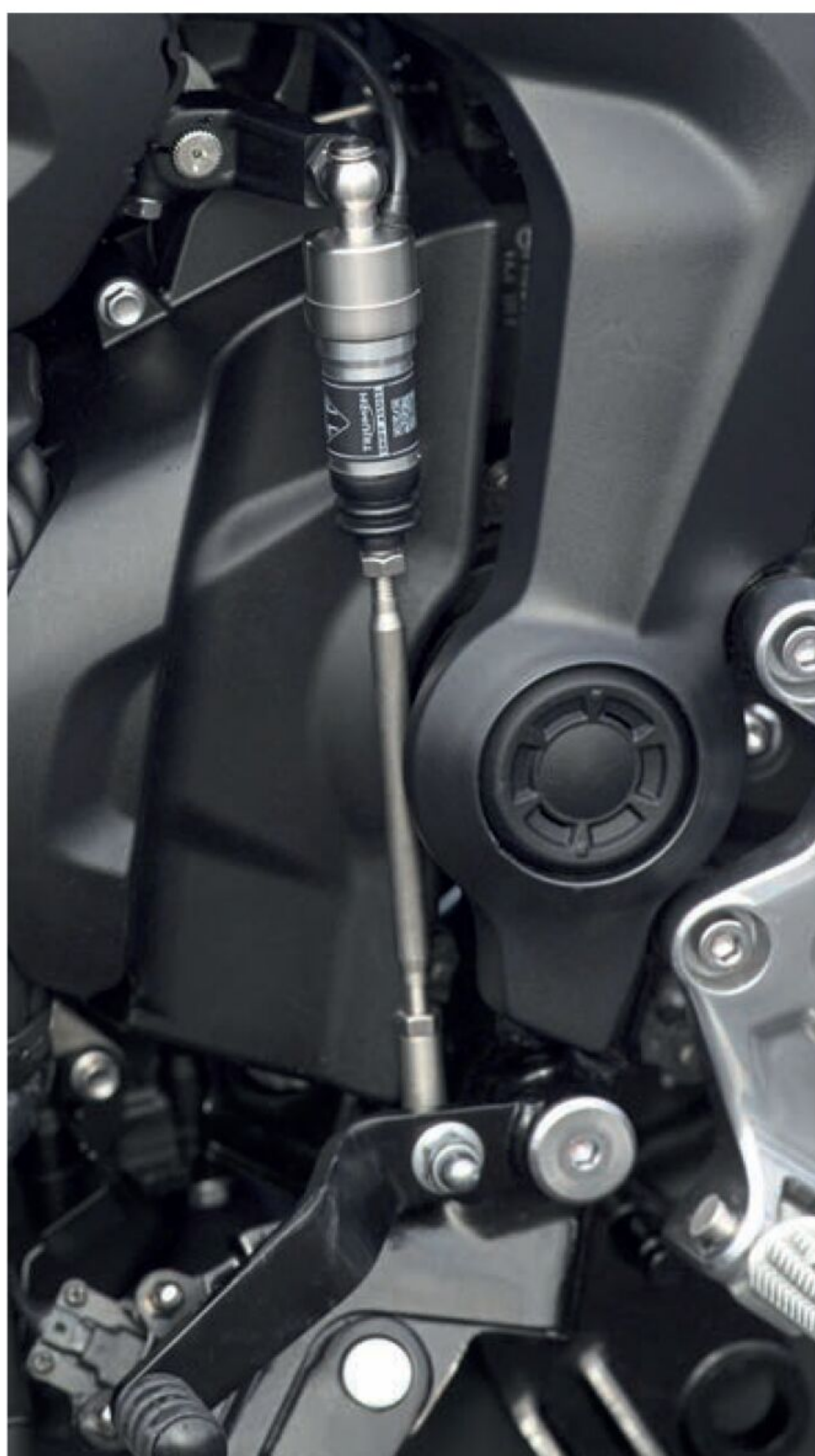
Quickshifteren i nærbilde. Snart standard på de fleste motorsykler. Smidig!
