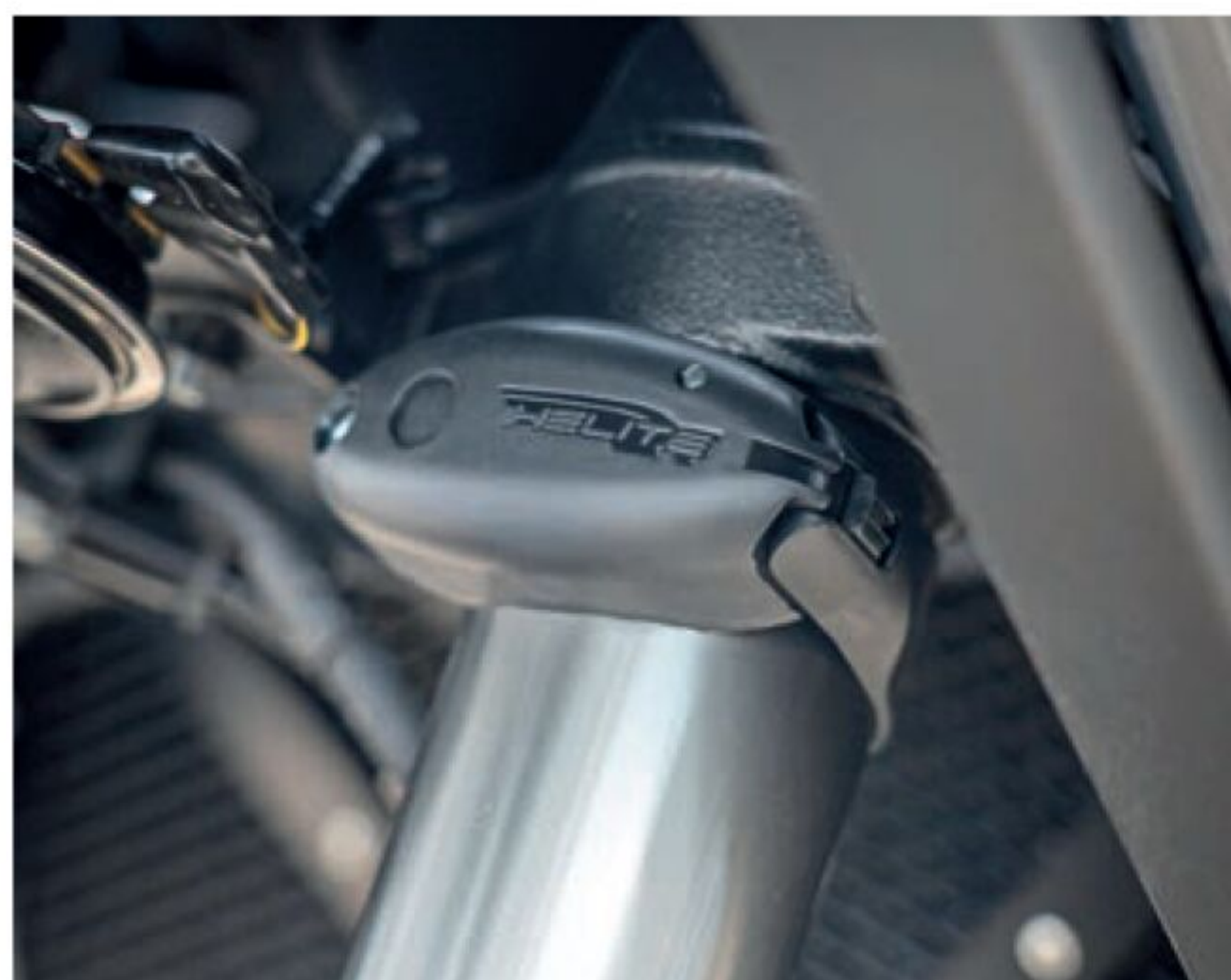
Den ekstra gaffelsensoren er ment å halvere utløsningstiden til 31 ms. Ikke egnet for banekjøring.
