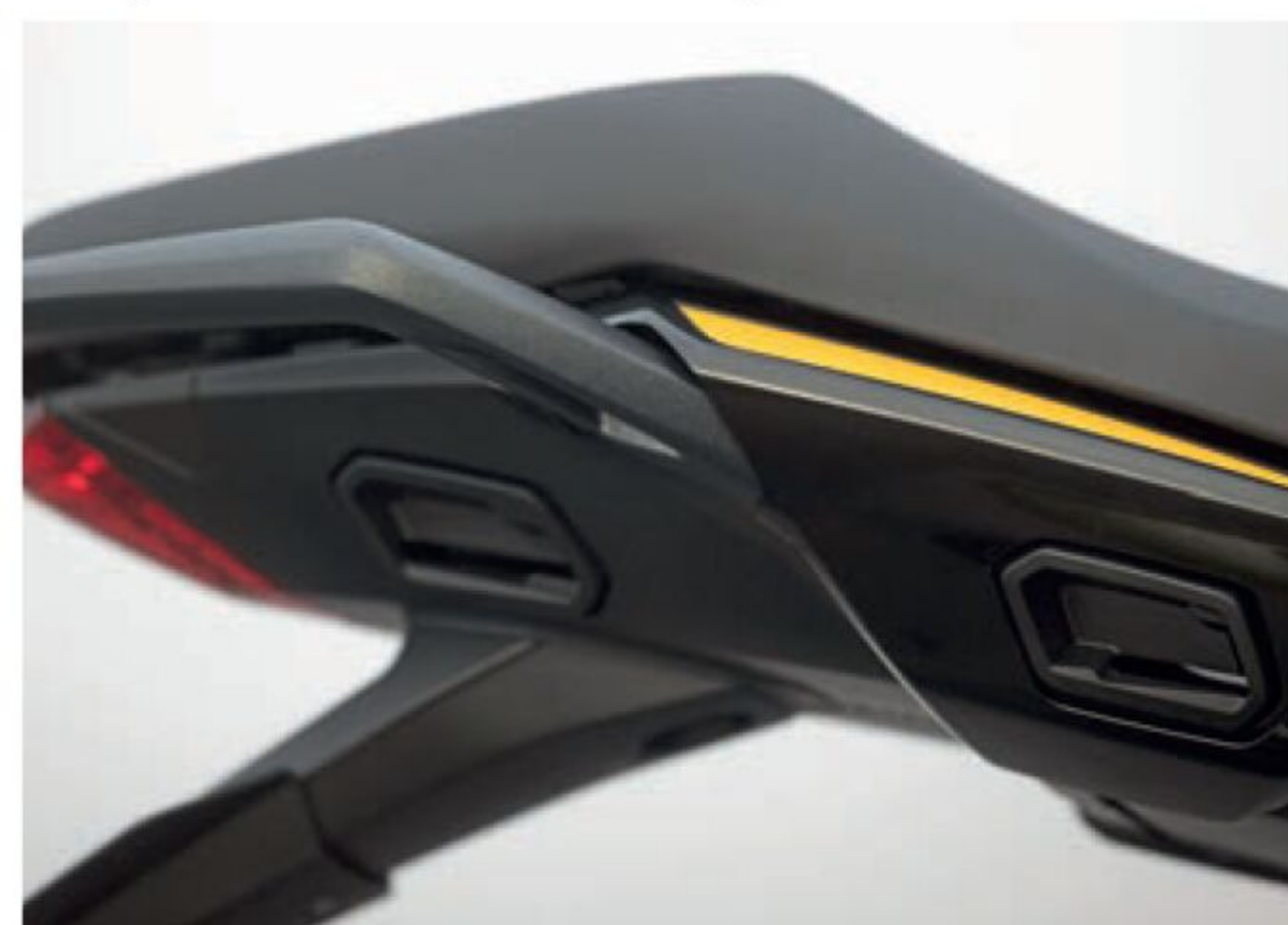
Festepunktene til sideveskene er svært diskrete, nesten usynlige, men gir likevel stabilt feste for originalveskene som leveres som ekstrautstyr.
