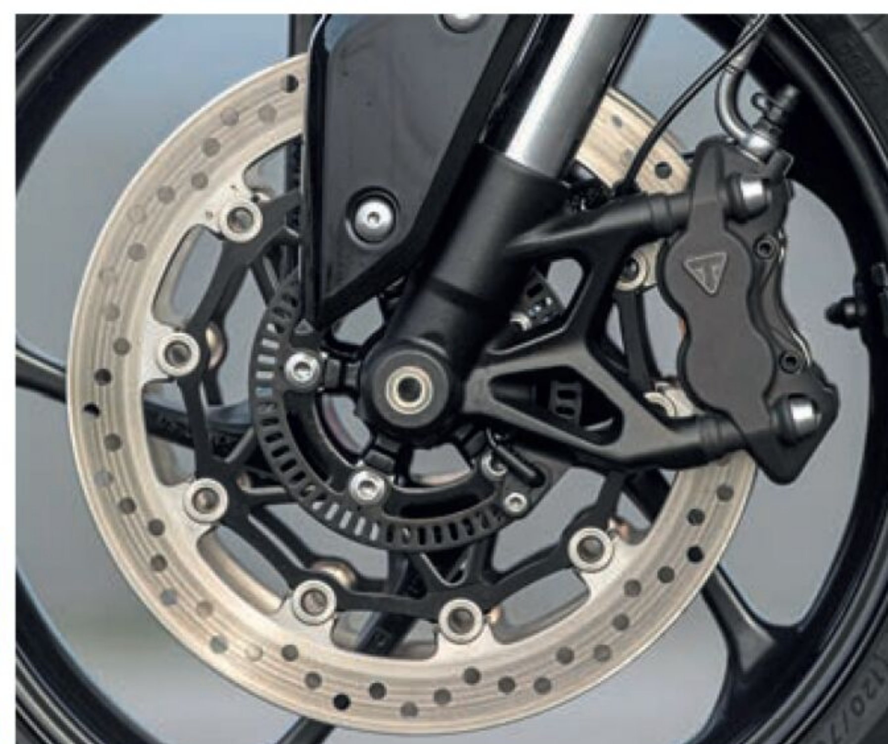
Til tross for Triumph-logoen på bremsekaliperne, er det J.Juan som har produsert dem. Biter godt.
